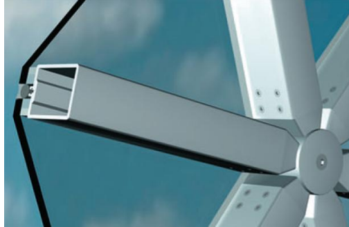
Şekil 6.15 Kutu profilli birleşim tipi [188]
