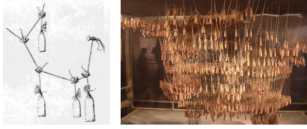
Şekil 3.7 Gaudi'nin çekme deneyi ve asılı zincir modeli [22]
