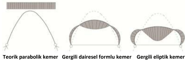
Şekil 3.20 Kemer enkesit tipine göre eğilme momenti dağılımı
