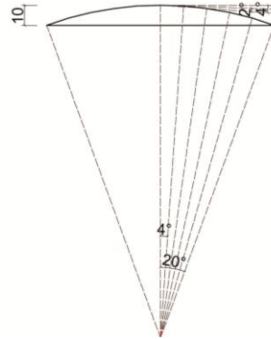
Şekil 3.44 100 x 30 m ve 100 x 10 m boyutlarındaki iki kubbenin nervür 1 , çember sayısının belirlenmesi
