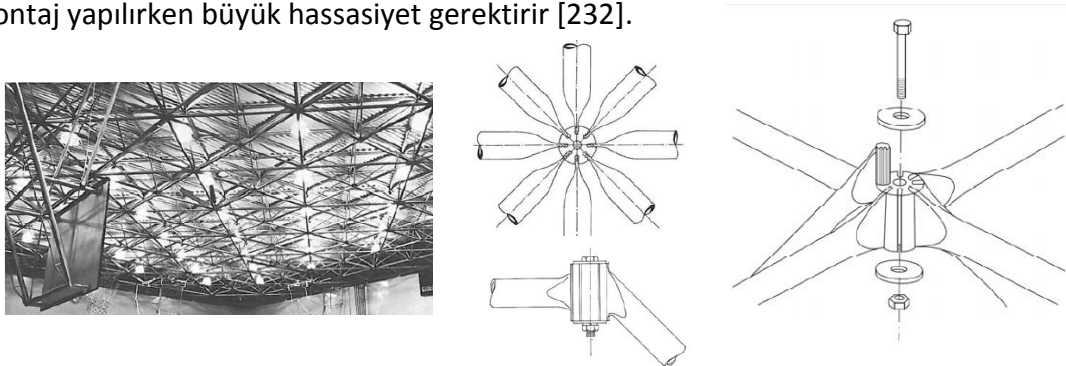
Şekil EK-1.33 Triodetic birleşim detayı [233], [237]
