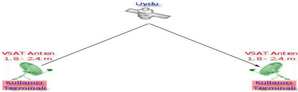
Şekil 5.1. Uydu ağ'ında mesh topolojisi
