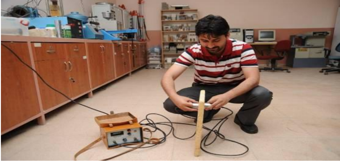
Şekil 4.2. Yalıtım numunesine ultrasonik ses deneyinin uygulanması
