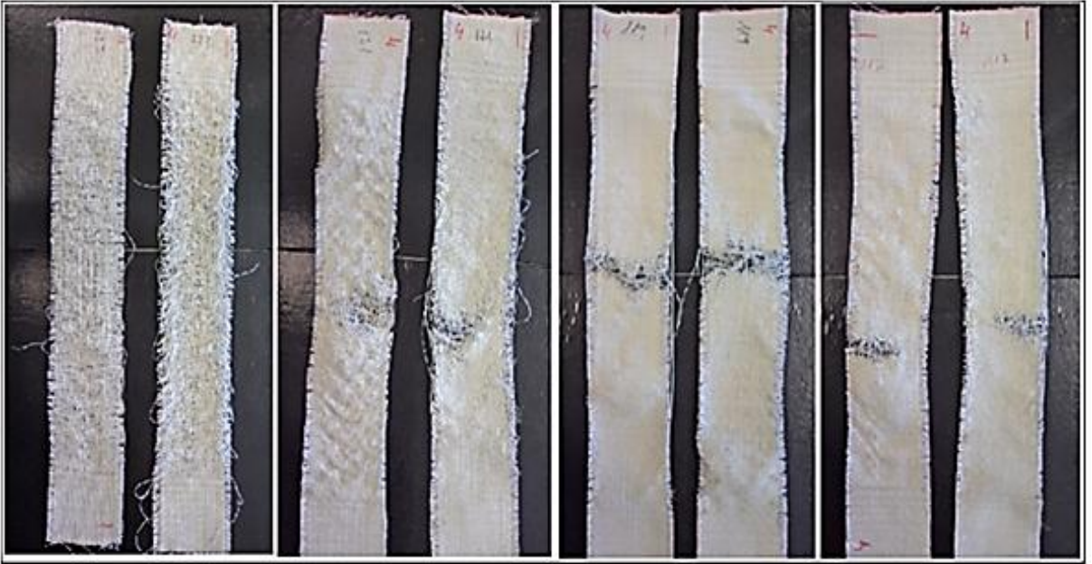
Şekil 3.18. Kopma mukavemeti sonrası kumaşlardaki farklı deformasyonlar ve değişimler
