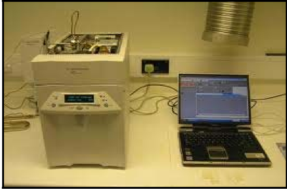
Şekil 2.3 Agilent 6850 gaz kromatografi (GC) cihazı
