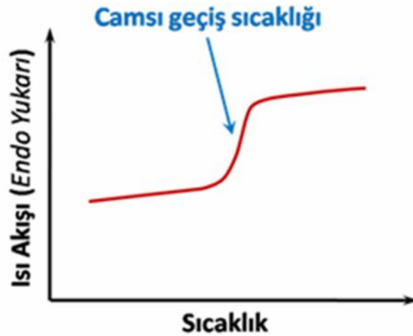
Şekil 2.12. Camsı geçiş sıcaklık grafiği [47]
