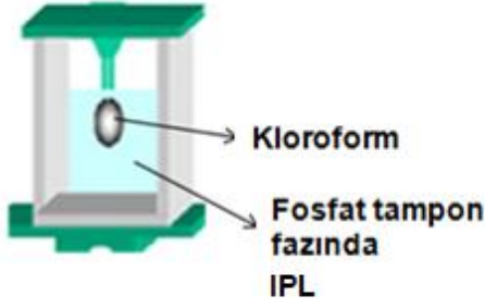
Şekil 3.7 IPL molekülünün fosfat tampon fazından ara yüzeye dinamik adsorpsiyon özelliğinin incelenmesi için kurulan deney sistemi
