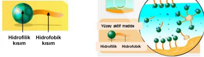
Şekil 2.2 Yüzey aktif maddelerin yapısı ve çözültideki davranışları
