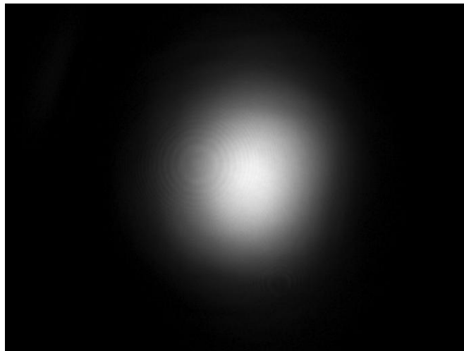
Şekil 6.2 : Femtosaniye lazer huzmesi profili yakın alan görüntüsü.
