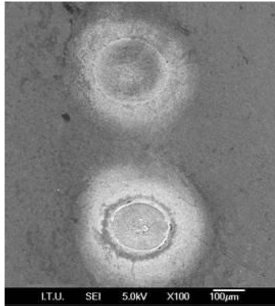
Şekil 6.5 : 100 (üst) ve 1000 (alt) darbe ile aşındırılmış alüminyum SEM görüntüsü.
