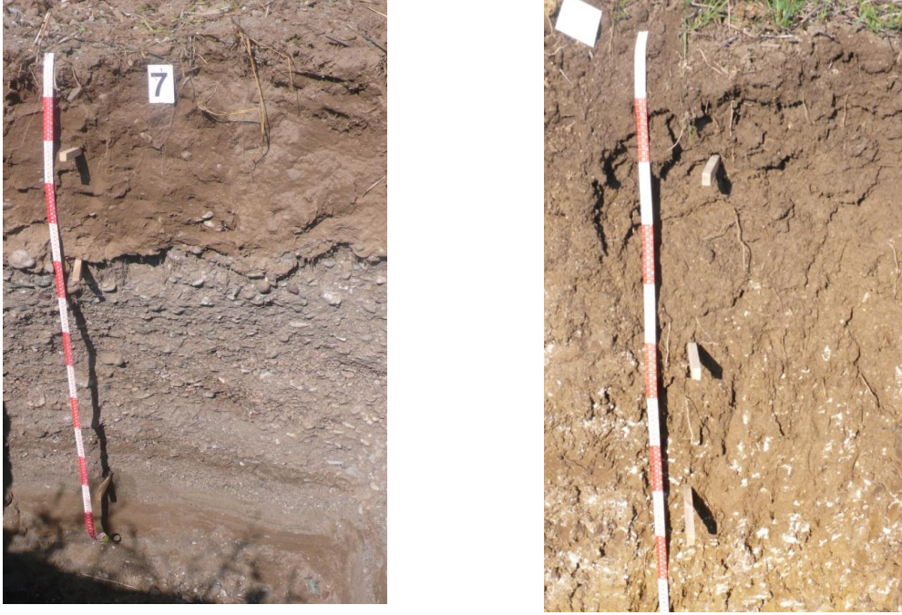
Şekil 3.8. Toprak profillerinde bazı morfolojik çalışmalar ve bozulmuş-bozulmamış toprak örnek alımları
