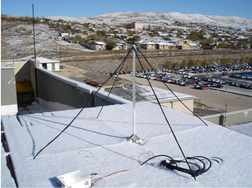
Şekil 3.2. Fen Fakültesi çatısına kurulan VLF alıcı sisteminin anteni.
