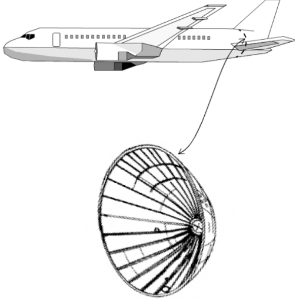
Şekil 4.1. Konik uçak duvarı yapısı örneği
