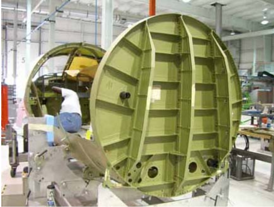
Resim 4.1. Basınç duvarı uçak üzerinde montajı örneği
