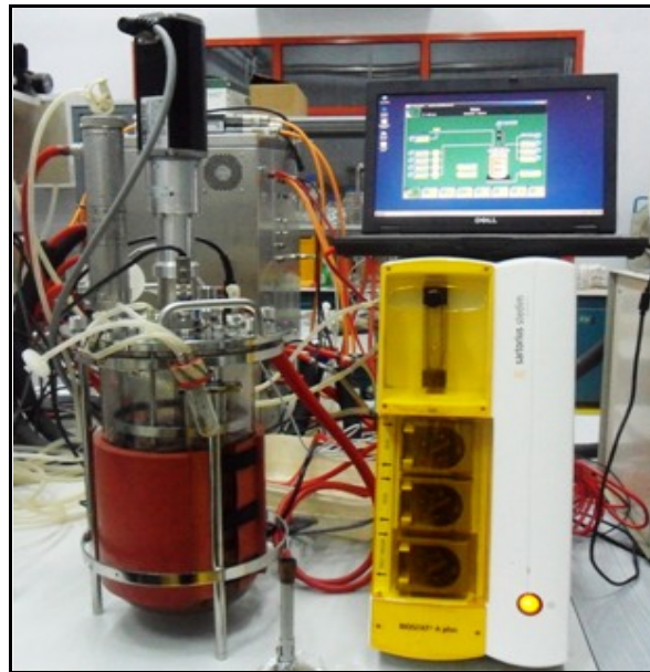
Şekil 4.24 Dört litrelik üretimin yapıldığı biyoreaktör ve kontrol paneli.
