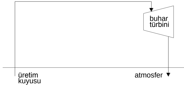
Şekil 3.3. Kondensersiz kuru buhar çevrim jeotermal elektrik santrali akış şeması [31].
