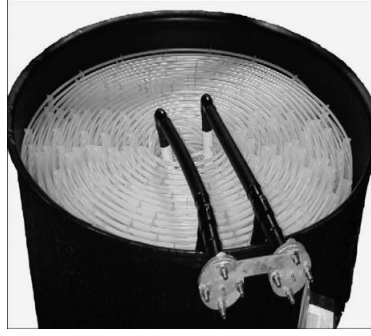
Resim 4.1. Serpantinli enerji (buz) depolama sistemi [8,49].
