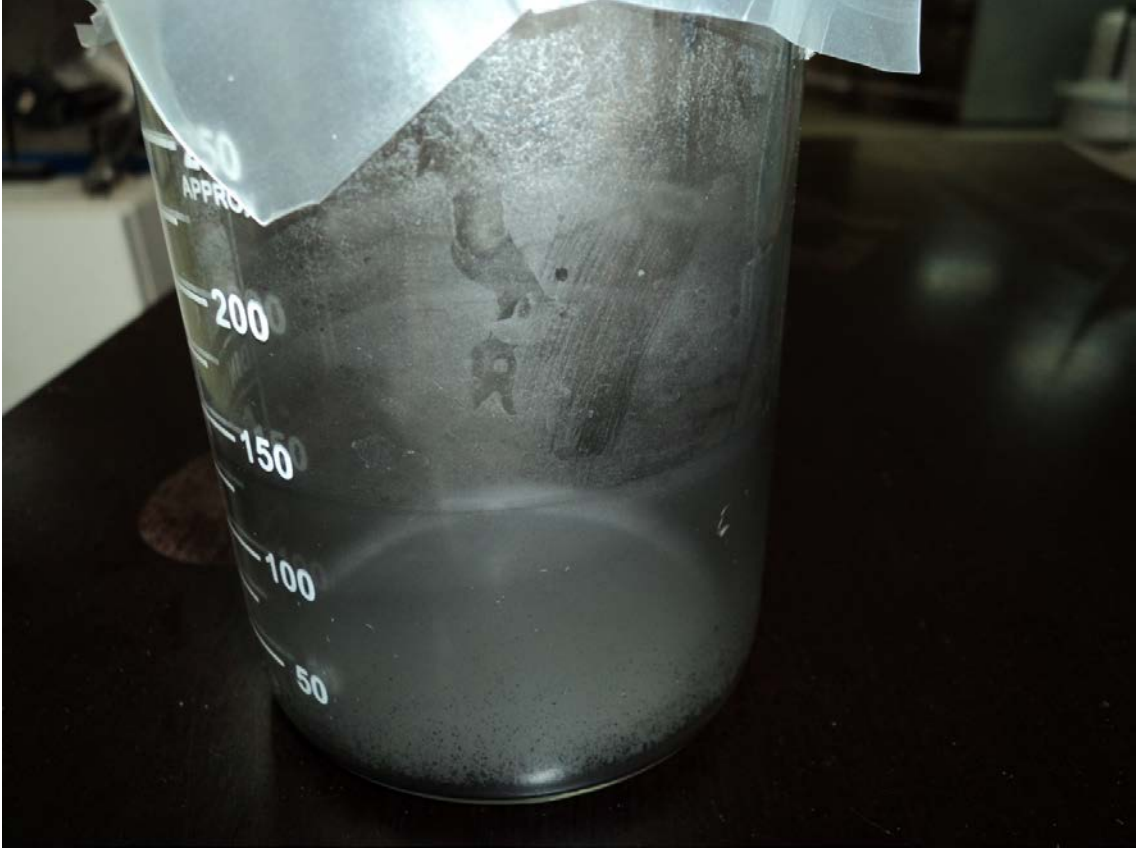
Şekil 3.3. Beher Yüzeylerinde Kalan GO_k Partiküller
