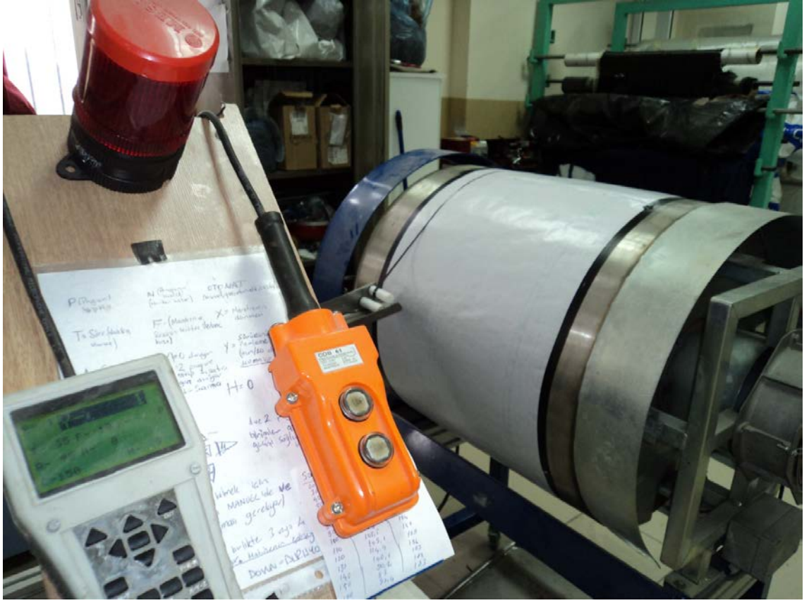
Şekil 3.6. Tambur Üzerine Yapıştırılan Yağlı Kâğıt ve Teflon Silindirlerden Gelerek Kâğıt Üzerine Yapıştırılan Karbon Fiber Demeti
