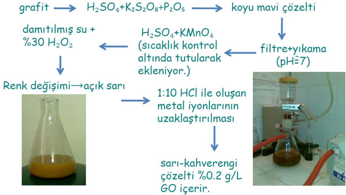
Şekil 3.1. Hummers Metodu İle Grafen Oksit (GO) Üretimi (Arseven 2010)
