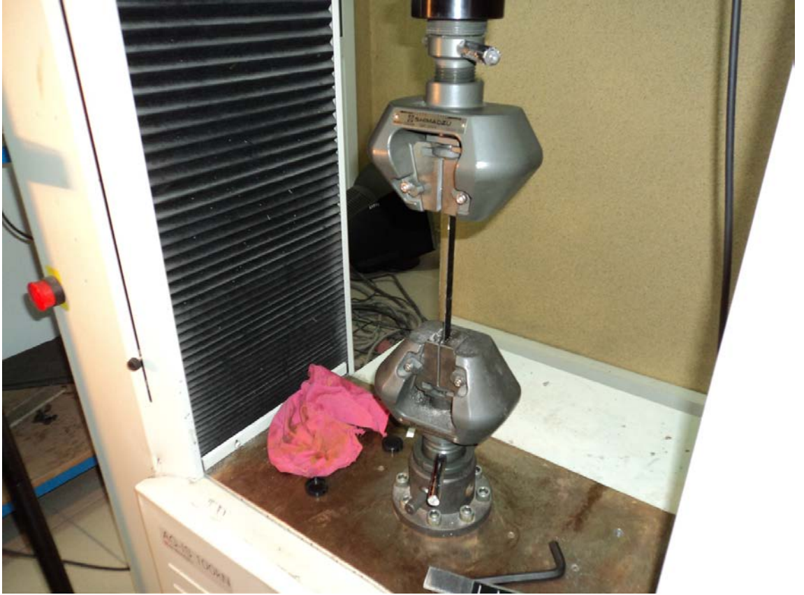
řekil 3.11. Shimadzu (Japonya) Universal Test Cihazında Çekme Testleri
