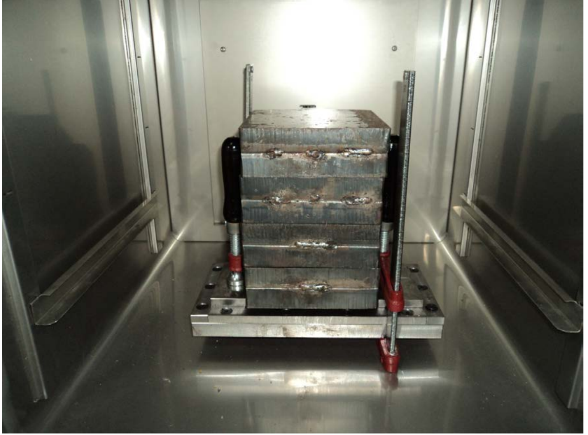
Şekil 3.8. Kompozit Üretim Kalıbı ve Kalıp Sıkıştırma İçin Kullanılan Yükler
