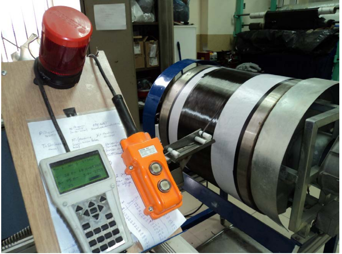
Şekil 3.7. Oda Sıcaklığında 210 mm Genişliğinde Elyaf Sarımı
