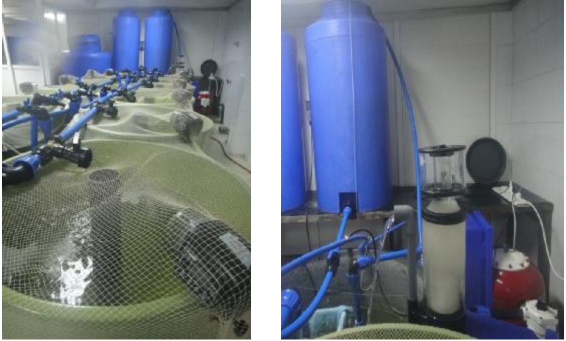
Şekil 3.1. Deneme Ünitesinin Dizaynı (Resirküle Sistem)
