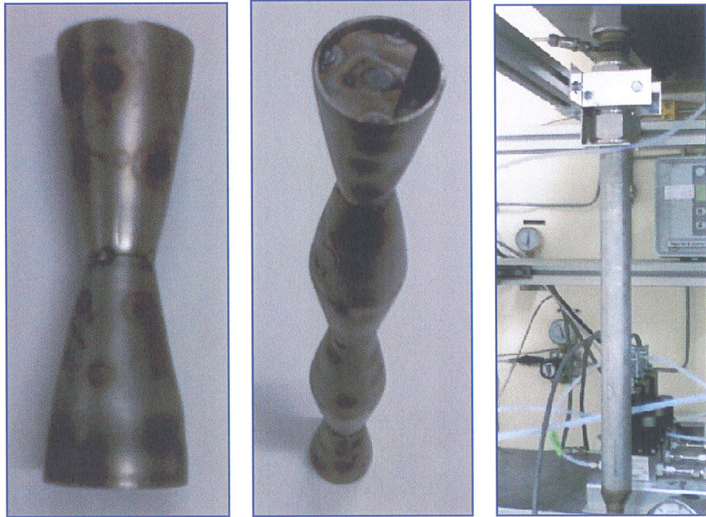
Şekil 3.11. Tasarlanan statik mikser ve içerisinde kullanıldığı kolon
