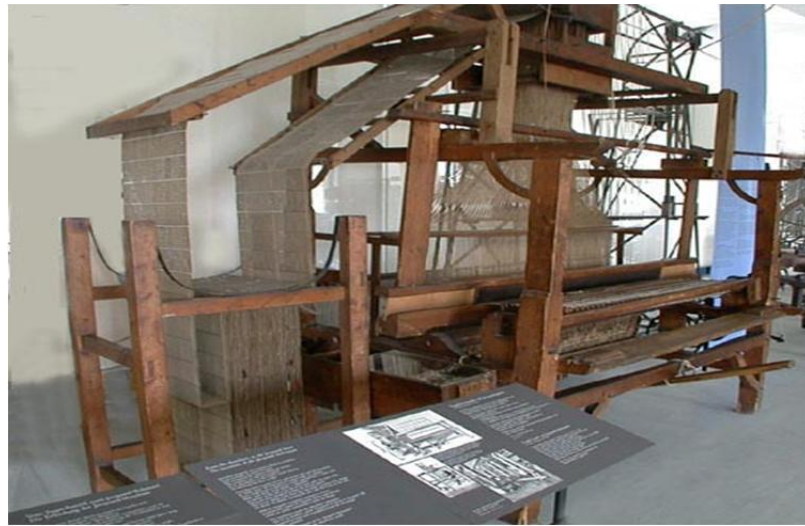
Resim 5. Jacquard'ın delikli kartlar ile çalışan programlanabilir dokuma tezgahı ( http://upload.wikimedia.org/wikipedia/commons/5/5f/Jacquard.loom.full.view.jpg )
