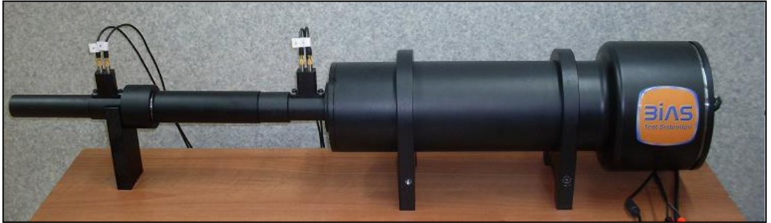
Şekil 4.8 : Susturucu ses iletim kaybı ölçüm düzeneği imal edilmiş görünümü.
