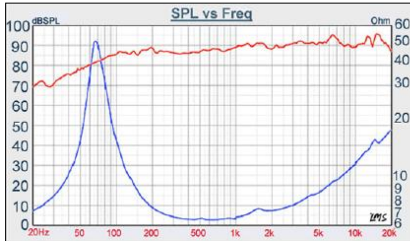
Şekil 4.5 : Akustik sürücünün, direnç ve ses düzeyi eğrileri [19].
