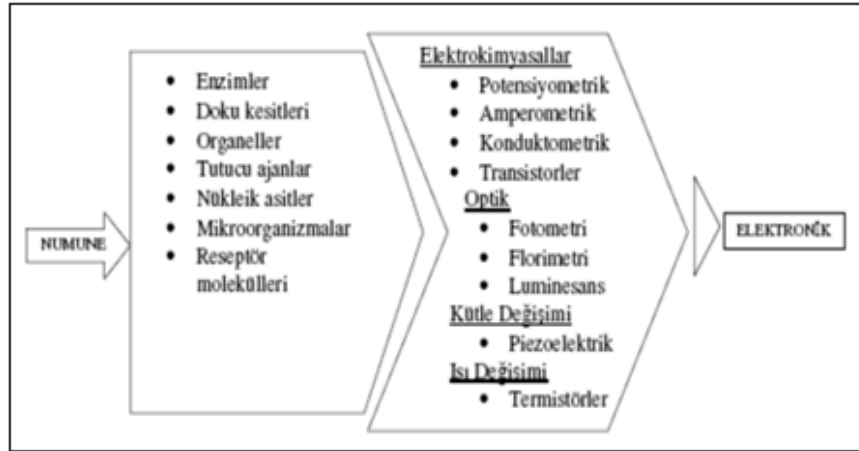
Şekil 2.30. Biyosensörlerin çalışma prensibi
