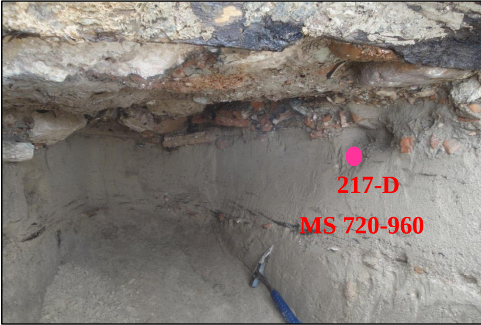
Şekil 4.100. 6. Birimden alınan numune yerini (pembe nokta) gösteren fotoğraf. Kumun üzerinde görülen temel kazı alanındaki deniz fenerinin temelidir. 217-D numaralı numunenin yaşı dolaylı olarak deniz fenerinin yapımının en erken başlangıç yaşını vermektedir.
