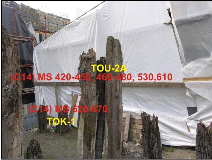
Şekil 4.83. 4. birimde tsunami öncesi (TOK-1) ve sonrasına (TOU-2A) ait iskele kazıklarından alınan ahşap numunelerin C^{14} tarihlendirmesi sonuçları (Batı kesitinin yakınındaki iskelenin güney ucundan alınmıştır).
