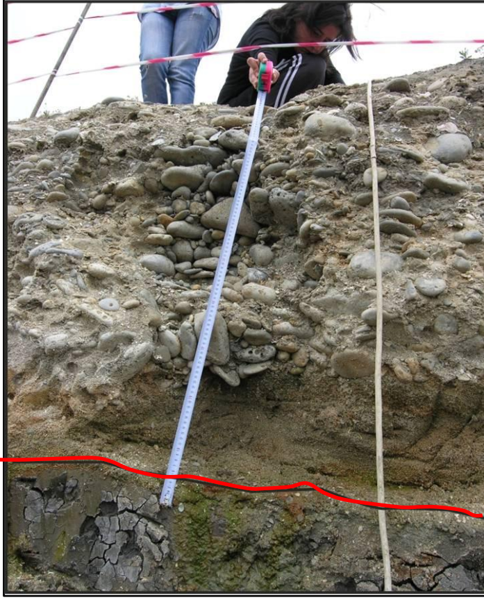
Şekil 4.57. 2. Birimde tane boyunda gözlenen değişimler. Birimin bu lokasyondaki kalınlığı 95 cm dir ( Bakış yönü güneyden kuzeye).
