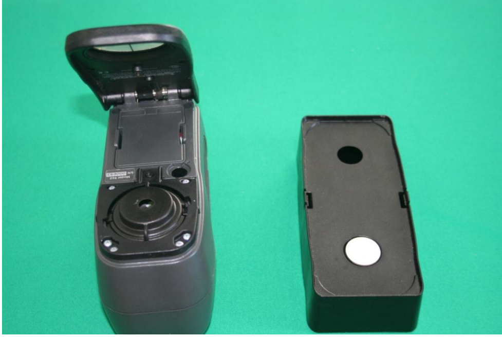
Şekil 7. Renk analiz cihazı optik okuyucusu ve kalibrasyon sehpası
