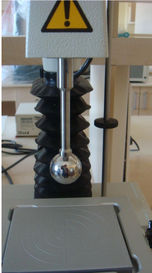
Şekil 4. TA.TXP Plus Texture Analyzer (Ball stainless prob ve tabla)
