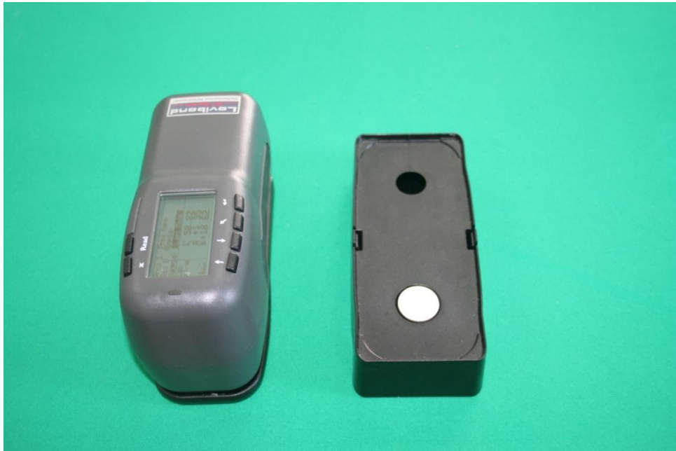
Şekil 6. Renk analiz cihazı ve kalibrasyon ünitesi
