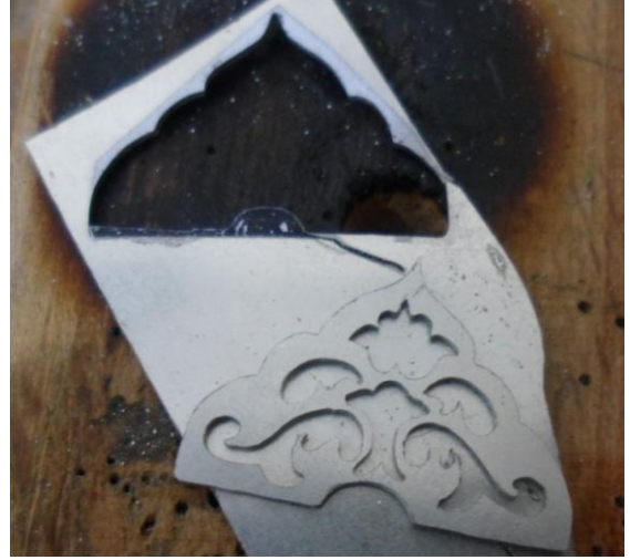
Fotoğraf 77. Kıl Testeresi Kullanma İşlemi Fotoğraf 78. Ajur Tekniğinin Uygulanması 1
