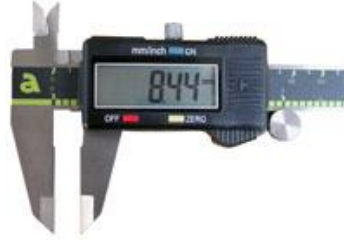
Şekil 57. Hassas Dijital Kumpas
