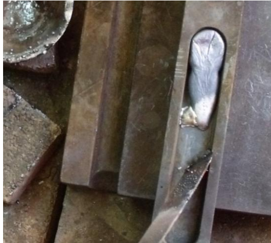
Fotoğraf 70. Uygulama Çalışması Astar Yapımı
