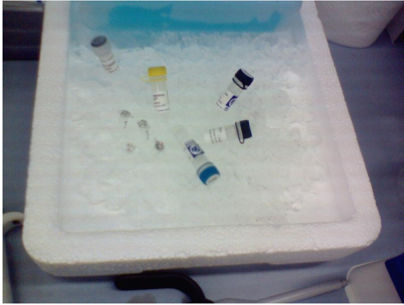
Şekil 5.10.2: Tüm PCR solüsyonları her an +4°C’de olmalı ve bu derecede karışım hazırlanmalı
