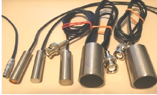
Şekil 3.9 Ultrasonik boyuna dalga gönderen temaslı transduserler.
