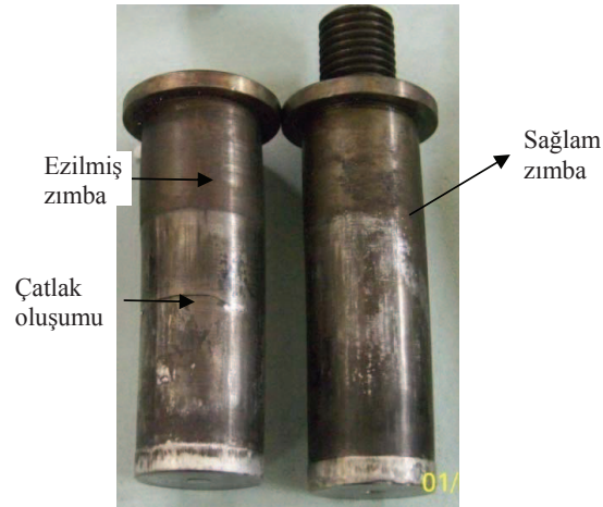
Şekil EK-2.5. Eğilmiş zımba.
