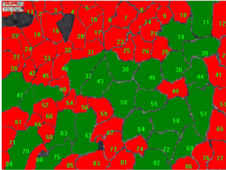
Şekil 3.5. %5 SiC takviyeli 3 geçişli TM numunenin numaralanmış taneleri.
