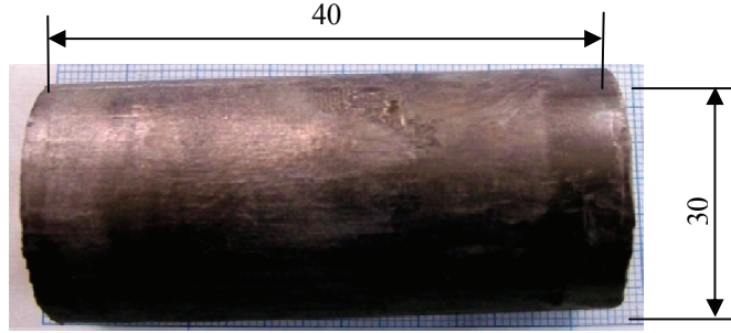
Şekil 2.10. Üretilmiş billet resmi ve boyutları.
