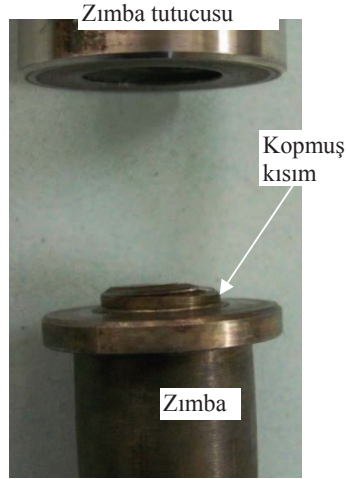
Şekil EK-2.7. Kırılmış zımba ve zımba tutucusu.
