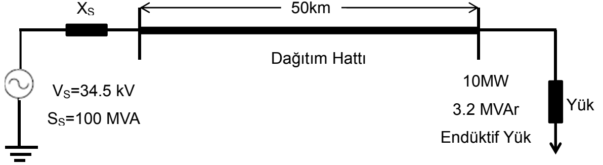
Şekil 3.7. Örnek güç sistemi-1’in tak hat şeması.
