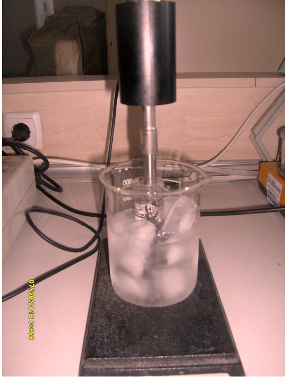
Resim 3.1. A.niger fungusunun hücresinin patlatılmasında kullanılan düzenek
