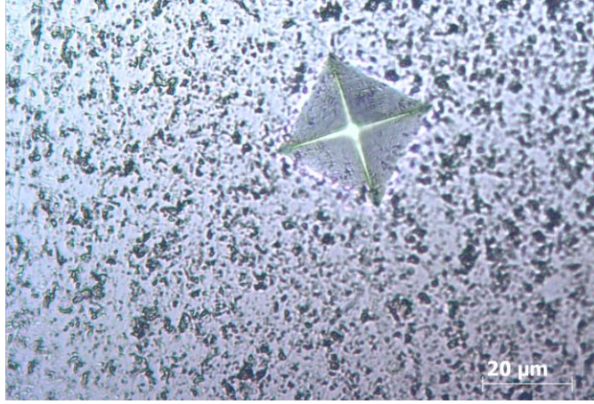
Şekil 4.24: Piston malzemesinin sertlik ölçümü
