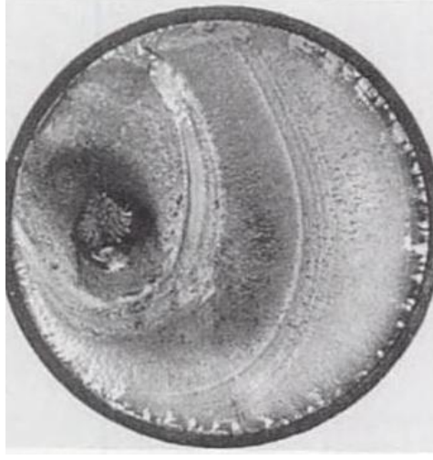
Şekil 3.7 : Yorulma sonucunda kırılma [16]
