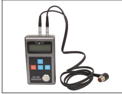
Resim 8: Ultrasonik kalınlık ölçüm cihazı (K&M Instruments Ltd., Hong Kong)
