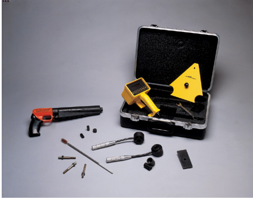
Şekil 2.13. Windsor probe test cihazı kiti (Qualitest, 2012)
