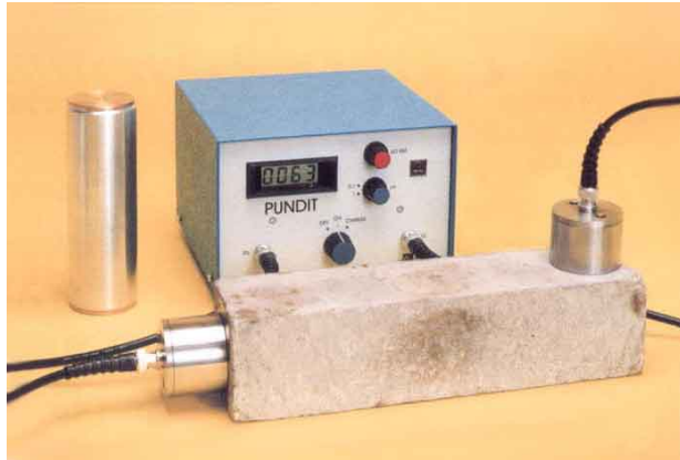
Şekil 2.10. Ultrases test cihazı (Alibaba, 2012)
