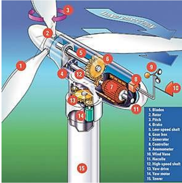
Şekil 1.12. Asenkron bir rüzgar türbininde nasele(nacelle)'in iç yapısı(Demir, 2007)
