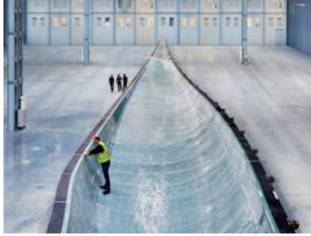
Şekil 1.14. Dünyanın en uzun türbin kanadının (fiberglas) üretiminden görünüm
