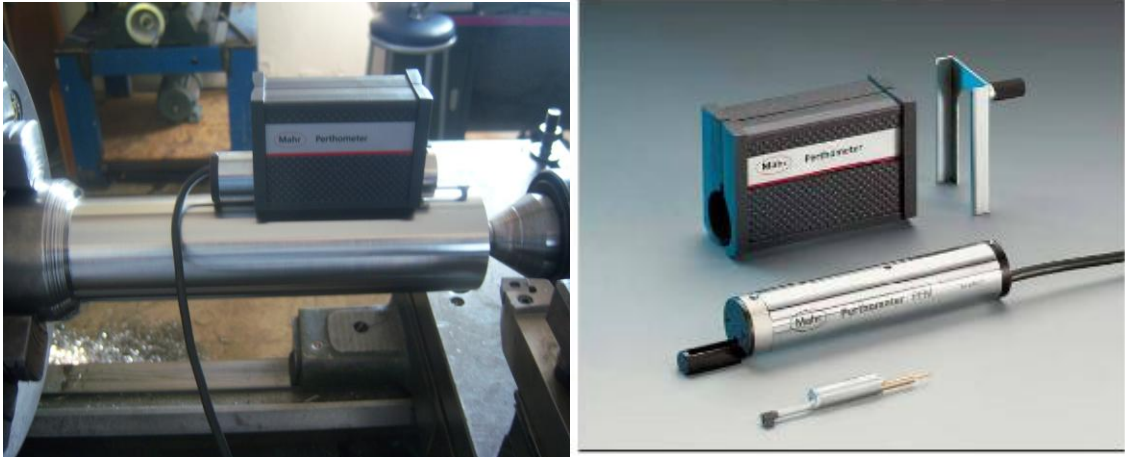
Şekil 3.7 Deneylerde kullanılan yüzey pürüzlülük cihazı ve ölçüm şekli
