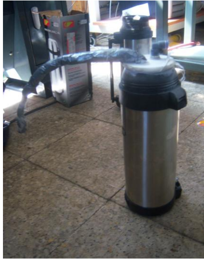
Şekil 3.4 Sıvı azotun depolandığı ve kesme esnasında kullanılan mini tank
