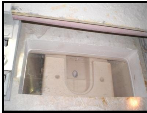
řekil 4.22. Saydam pencereli kalıbın stten grnř
