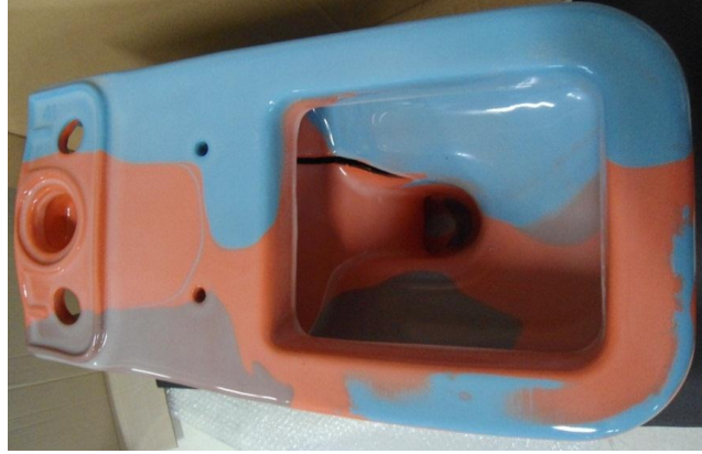
Şekil 4.25. Renkli döküm denemesinde çatlak görünümü
