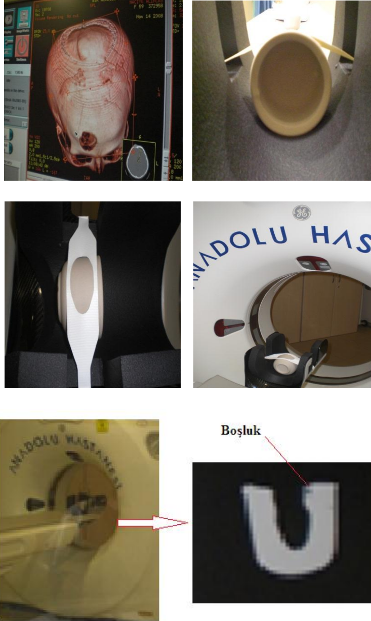
Şekil 4.20. Çamurdaki hataların tespiti için yapılan tomografi çalışması
