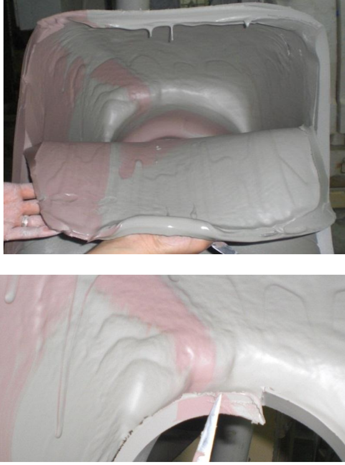
Şekil 4.24. Renkli döküm denemesinde kesilen klozetin iç kısmında, farklı yolluklardan beslenen çamurların ürün üzerindeki konumu ve süzüntü izleri
