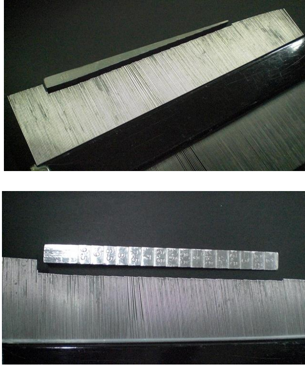
Şekil 2.8. Ürün yüzeyindeki deformasyonun belirlenmesinde kullanılan tasarım tarağı ve sentil çakısı
