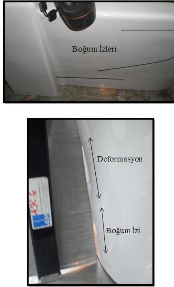
Şekil 5.2. Ürün üzerindeki boğum izi ve deformasyonun tasarım tarağı ile gösterimi
