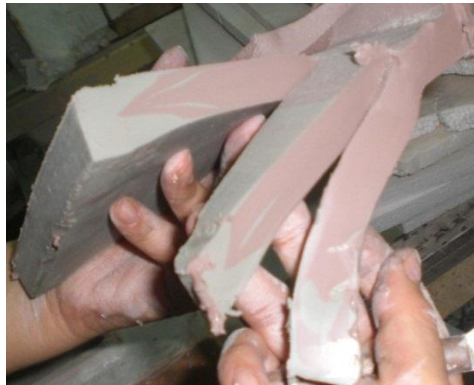
Şekil 4.23. Renkli döküm denemesinde kesilen klozetin et kalınlığı boyunca farklı yolluklardan beslenen çamurların kesitten görüntüsü
