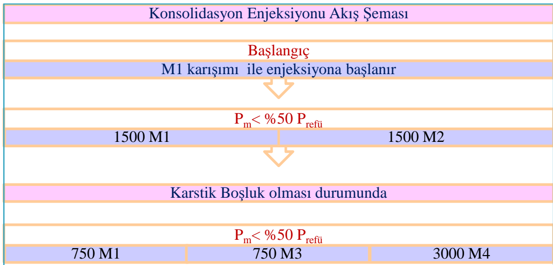
Şekil 5.5. Konsolidasyon enjeksiyonu akış şeması
