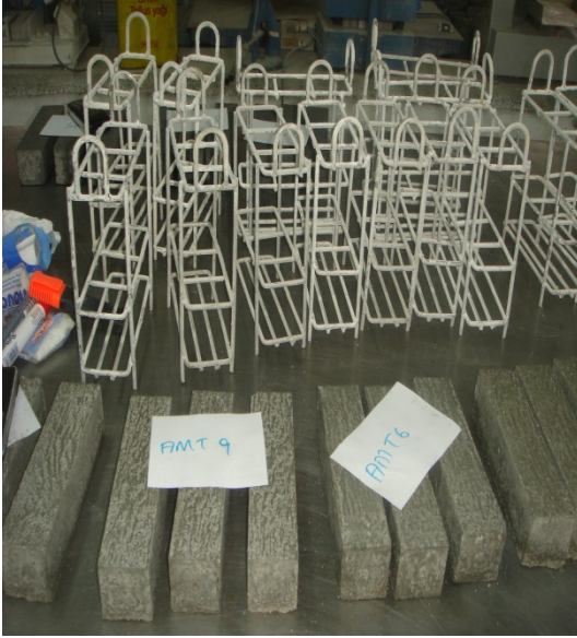
Resim 1.14. Harçların kalıptan çıkarılıp tel sepetlere konulması ve laboratuvar koşullarında kür edilmesi
