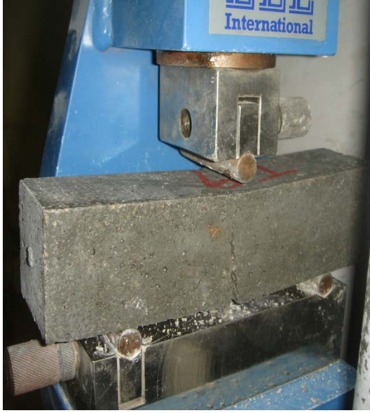
Resim 1.17. Harç numunelerine eğilmede çekme deneyi uygulanması
