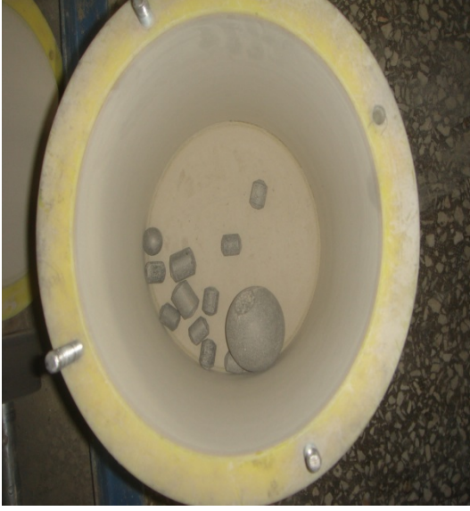
Resim 1.5. Çimento üretiminde kullanılan bilyalı değirmen
