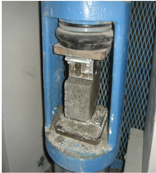
Resim 1.18. Harç numunelerine basınç deneyi uygulanması
