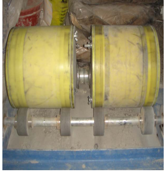
Resim 1.5. Çimento üretiminde kullanılan bilyalı değirmen
