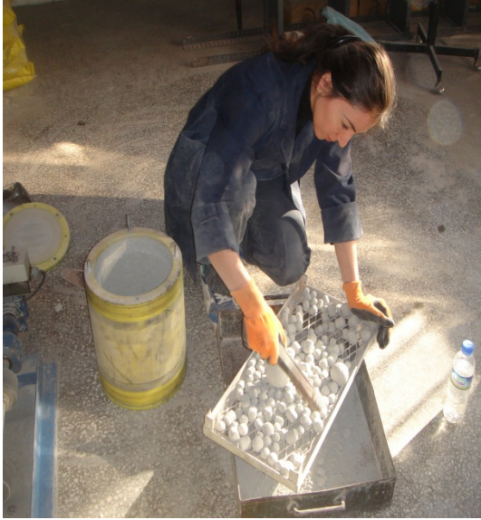
Resim 1.6. Çimentoların bilyalı değirmenden alınması
