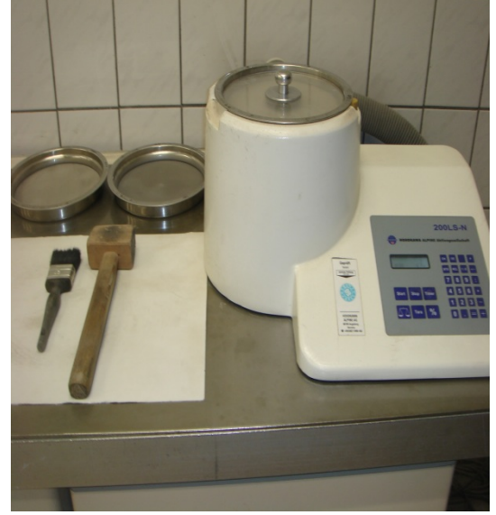
Resim 1.9. İncelik tayininde kullanılan Sartorius Basic elektronik terazi ve Alpine inceleme cihazı
