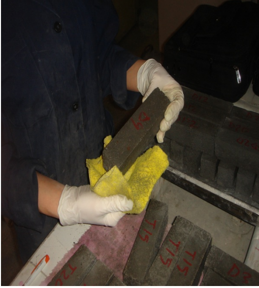
Resim 1.15. Harçların nemli bezle kurulanması ve tartılması
