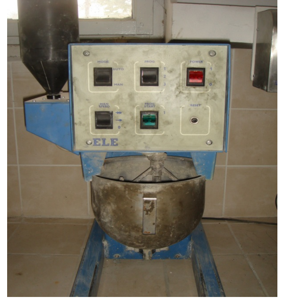
Resim 1.12. Harç karışımlarının hazırlanması ve mikserde karıştırılması.
