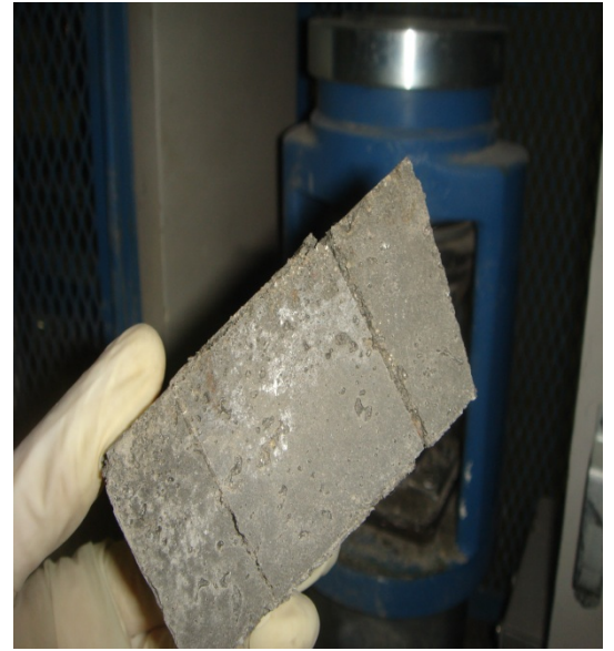
Resim 1.18. Harç numunelerine basınç deneyi uygulanması
