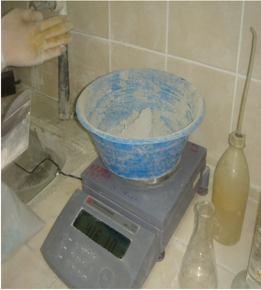
Resim 1.12. Harç karışımlarının hazırlanması ve mikserde karıştırılması.
