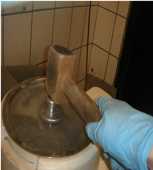
Resim 1.10. İncelik deneyinin yapılışı ve Micromeritics AccuPyc yoğunluk cihazı
