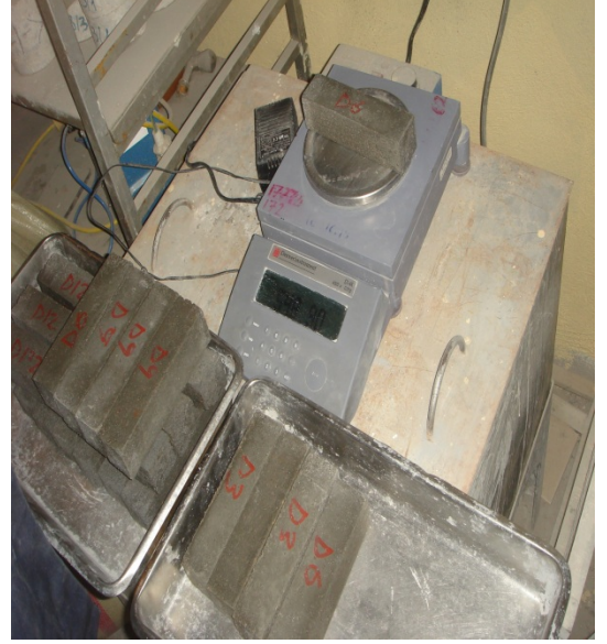
Resim 1.15. Harçların nemli bezle kurulanması ve tartılması
