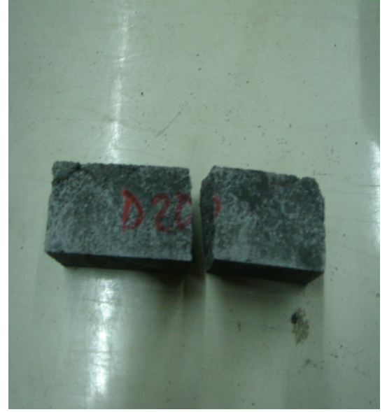
Resim 1.17. Harç numunelerine eğilmede çekme deneyi uygulanması
