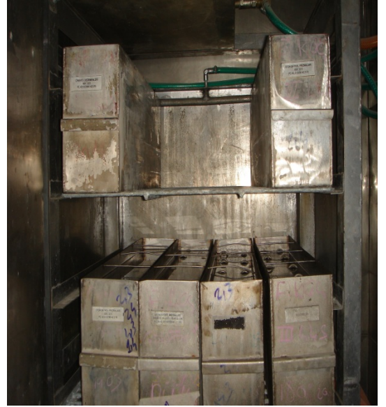
Resim 1.14. Harçların kalıptan çıkarılıp tel sepetlere konulması ve laboratuvar koşullarında kür edilmesi
