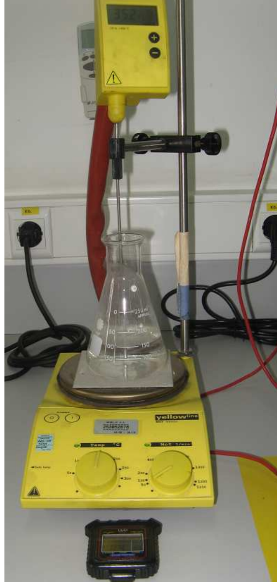
Şekil 7.24 : Kaplamalı plaka ile yapılan ısıtıcı deneyi ölçüm düzeneği görüntüsü
