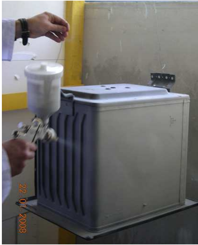
Şekil 6.1 : Kaplama işleminin gerçekleştirilmesi
