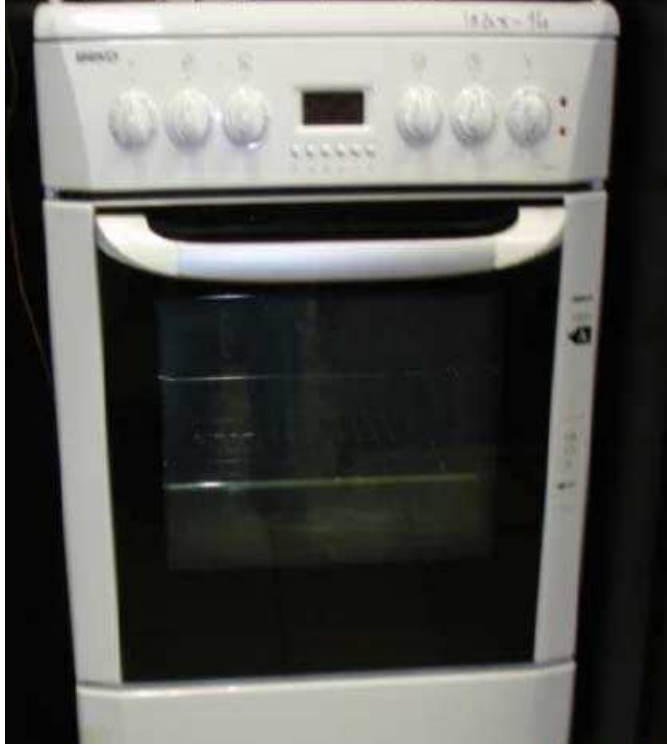
Şekil 6.12 : Kaplama uygulanan, enerji tüketim ve ısınma deneyleri gerçekleştirilen BEKO marka D1 6674T multifonksiyonel ev tipi fırın görüntüsü
