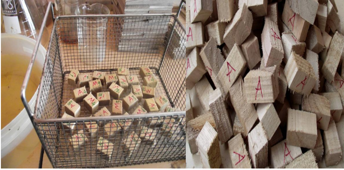
Şekil 3.9. Damıtık suda bekletme düzeneği ve deneme numuneleri.
