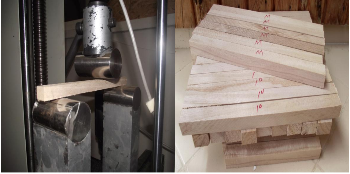
Şekil 3.11. Eğilme direnci deneyi, universal test cihazı ve deneme numuneleri.
