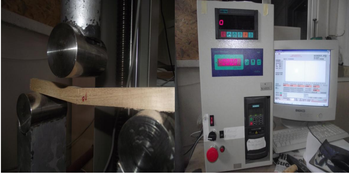
Şekil 3.12. Eğilmede elastikiyet modülü deneyi, üniversal test cihazı ve deneme numuneleri.
