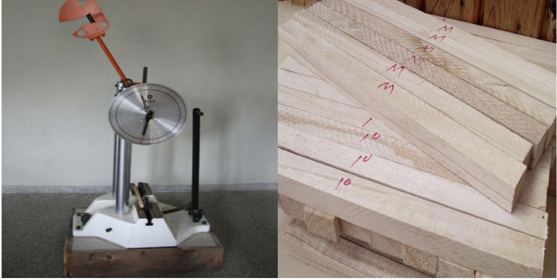
Şekil 3.14. Dinamik eğilme direnci deneyi, test cihazı ve deneme numuneleri.
