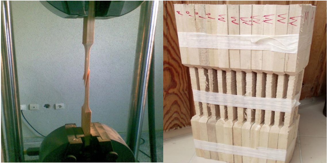
Şekil 3.15. Liflere paralel çekme direnci deneyi, test cihazı ve deneme numuneleri.
