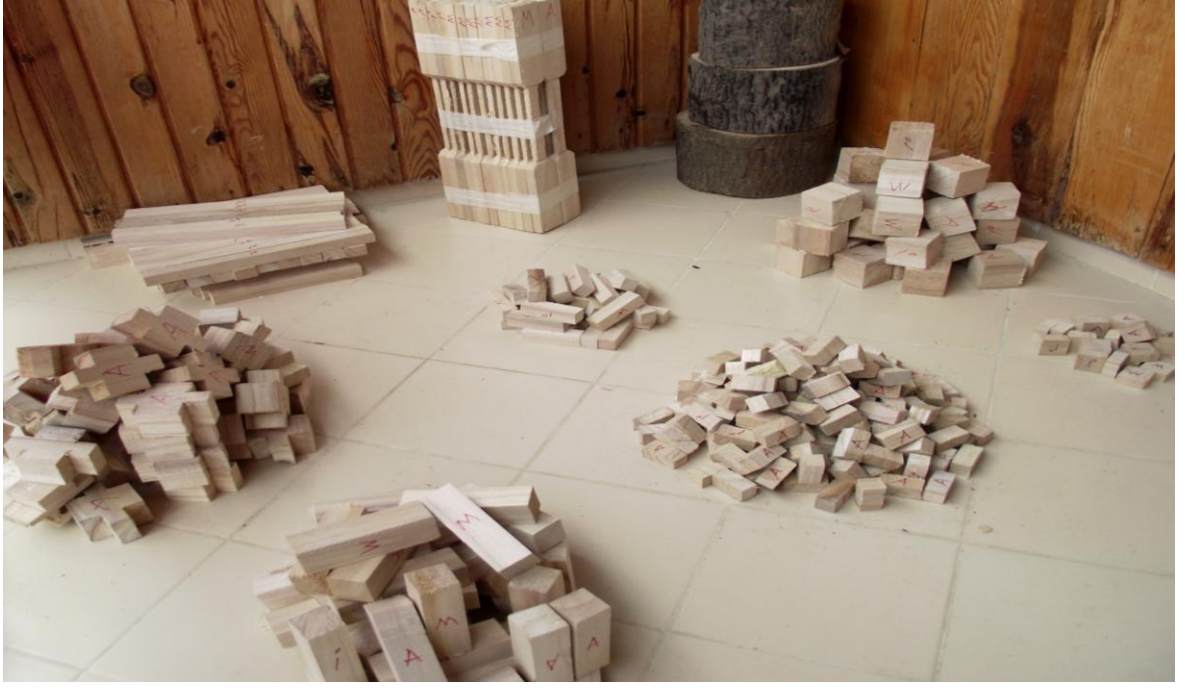
Şekil 3.5. Ebatlanmış ve kondisyonlanmış deneme numuneleri.
