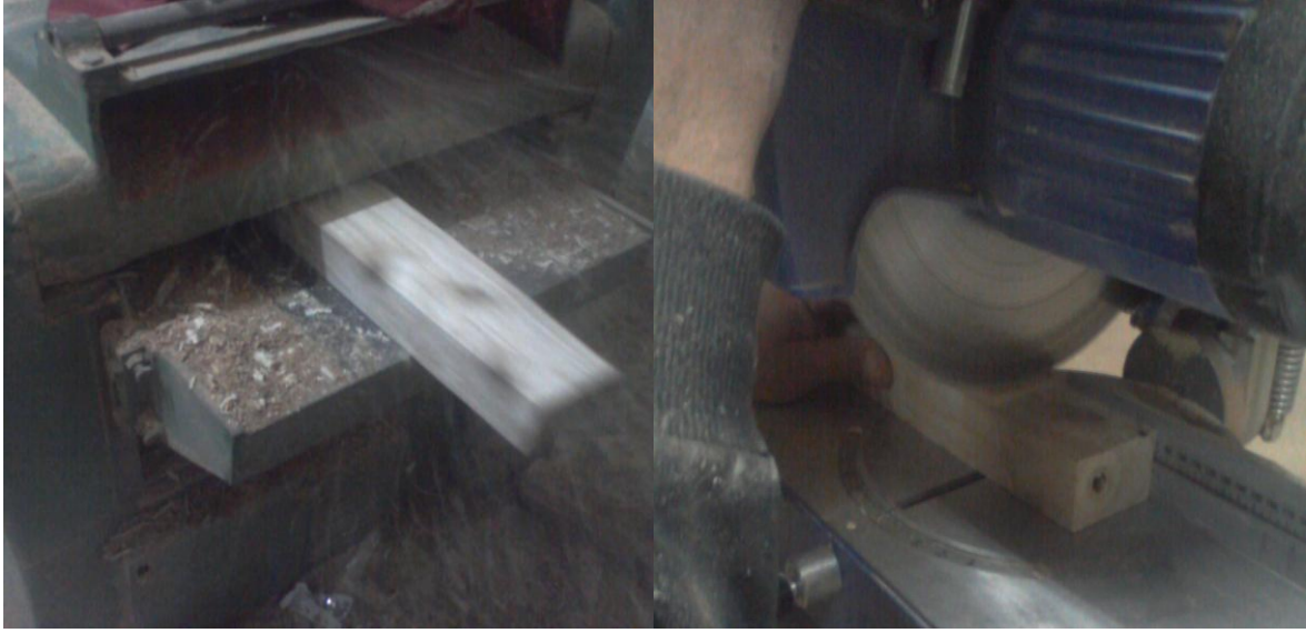
Şekil 3.4. Deneme numunelerinin şerit testere, planya, kalınlık ve boylama makinasında hazırlanması.
