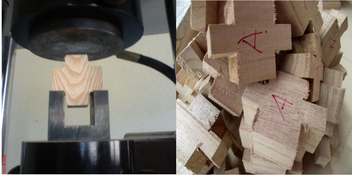
Şekil 3.13. Liflere paralel makaslama direnci deneyi, üniversal test cihazı ve deneme numuneleri.
