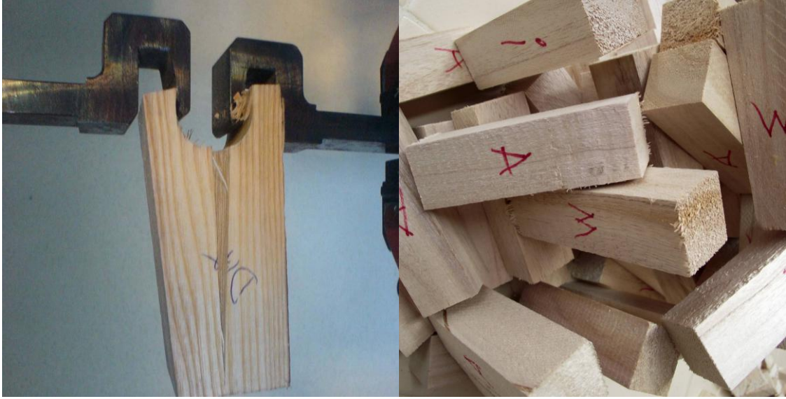
Şekil 3.16. Liflere dik çekme direnci deneyi, üniversal test cihazı ve deneme numuneleri.
