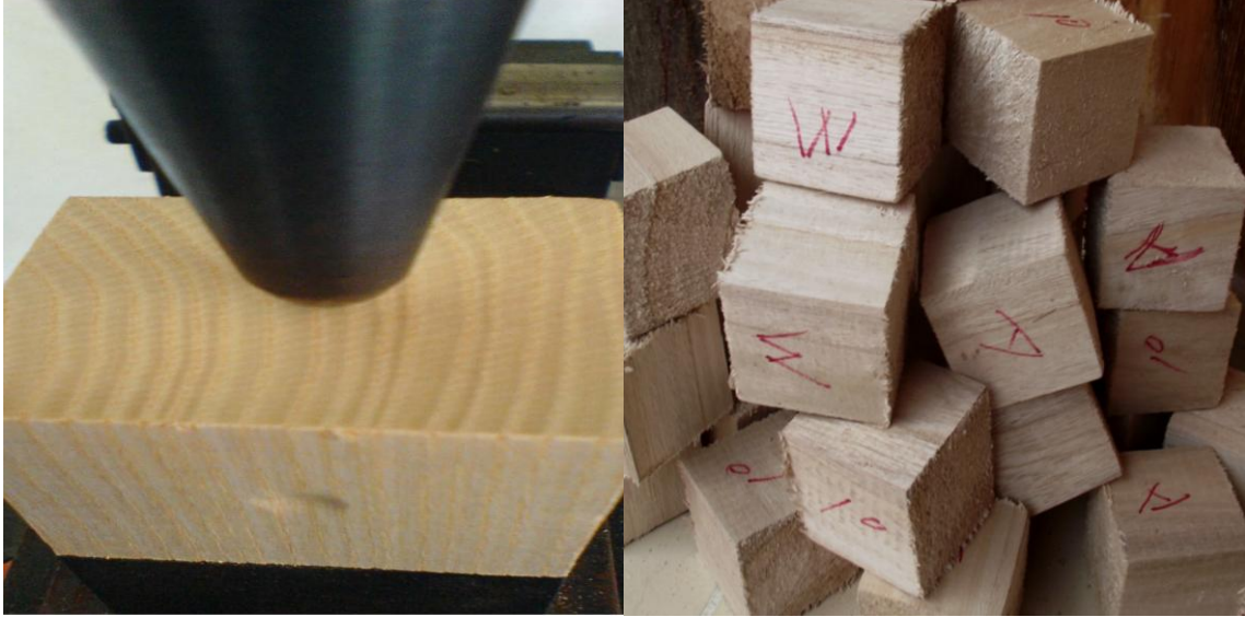
Şekil 3.17. Janka (sertlik) deneyi, niversal test cihazı ve deneme numuneleri.
