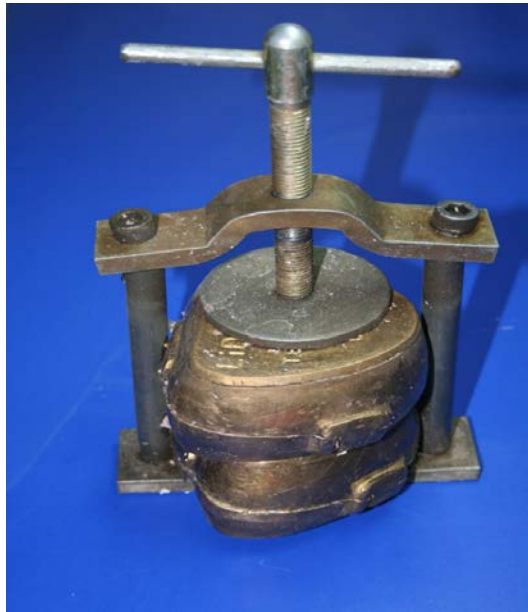
Şekil 3.30. Brit ile sıkıştırılan mufla kalıplar
