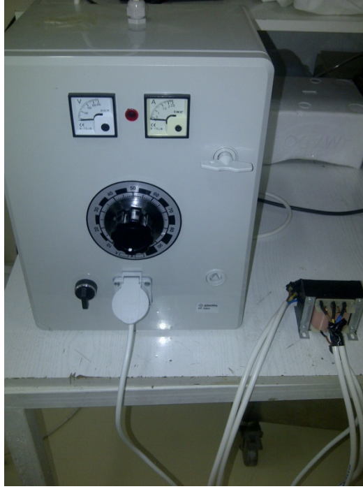
Şekil 3.22. Isıtıcı voltajının ayarlandığı transformatörler
