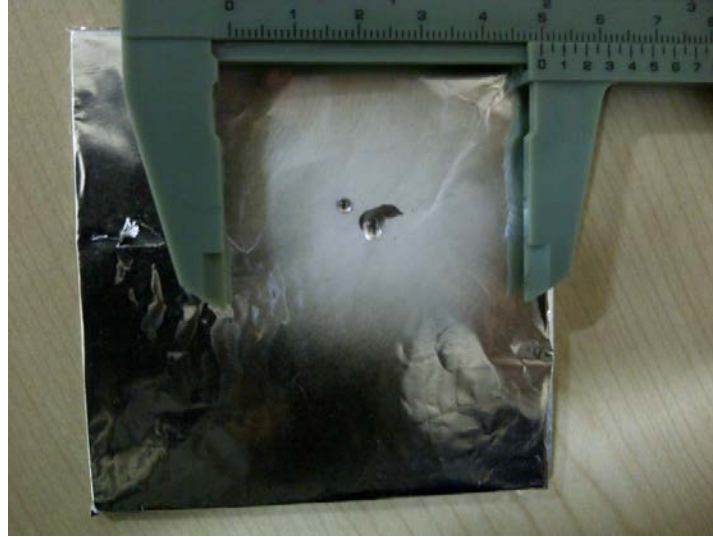
Şekil 4.4. Ağırılıkça % 25'lik PVA çözeltisinin birikim çapı ( R = 5\text{cm} )
