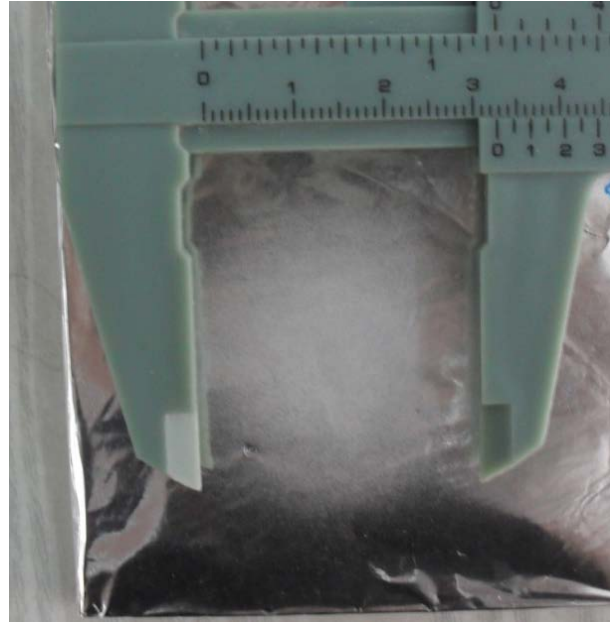
Şekil 4.7. Tasarım 1 ile elde edilen fiber matın birikim çapı (R=3.3 cm)
