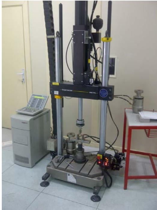
Şekil 3.33. Mekanik karakterizasyon için kullanılan Instron 8874 cihazı
