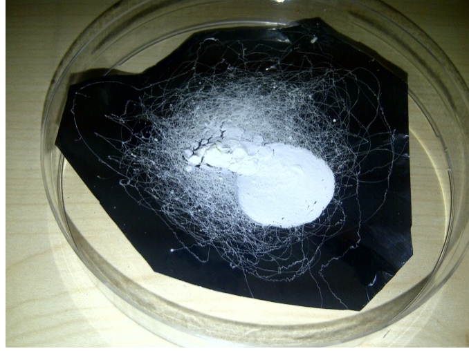
Şekil 4.19. HDPE fiberlerin alüminyum üzerindeki birikimi
