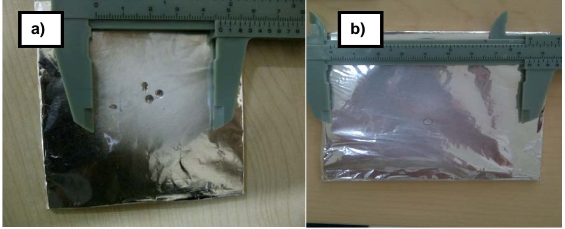
Şekil 4.15. Optik olarak elde edilen birikim çapları, a) Tasarım 3 b) Odaklayıcı halkası olmayan Tasarım 3
