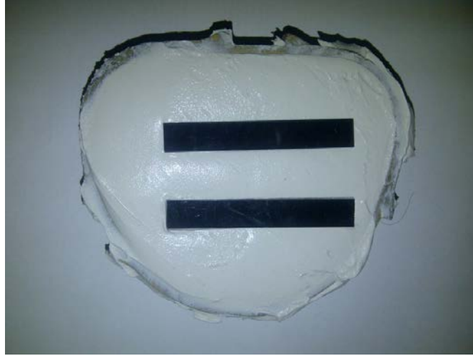
Şekil 3.29. Alçı içerisinde yerleştirilen kalıplar
