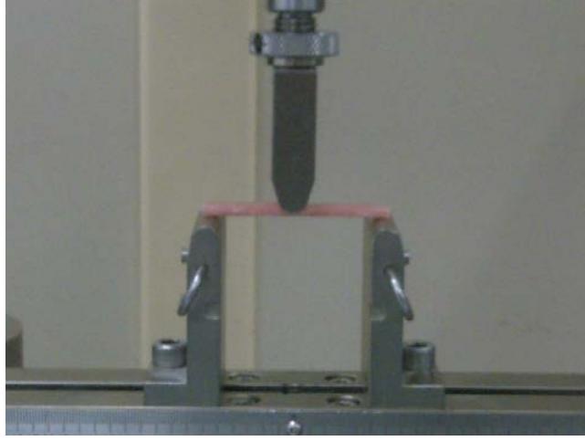
Şekil 3.34. Üç nokta eğme testi için yerleştirilen PMMA örnek
