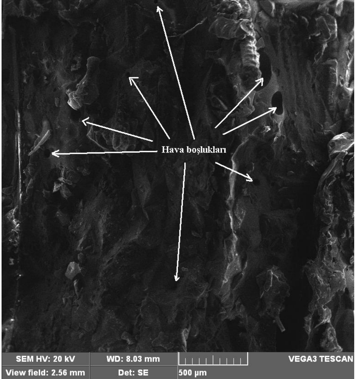
Şekil 6.20 Dolgu maddesi/bağlayıcı madde oranı 0,50 olan örneğe ait SEM görüntüsü ve oluşan hava boşlukları
