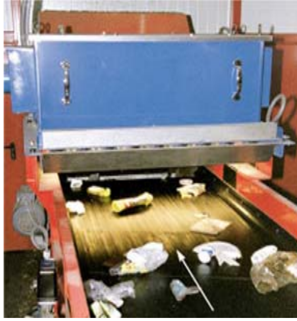
Şekil 2.6 Geri dönüşüm bandı üzerinde X-ray ve magnetik seperatör ile otomatik ayrıştırma
