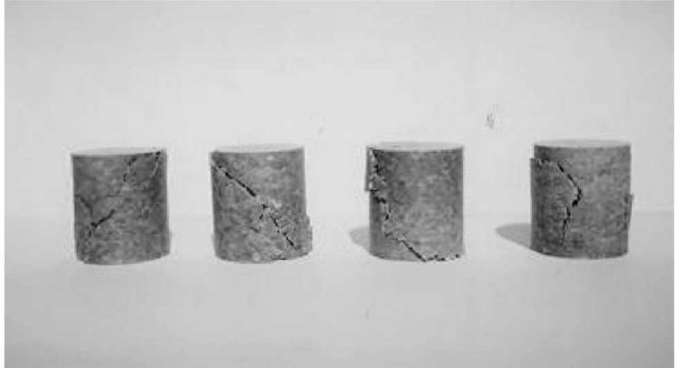
Şekil 4.12 60/40 oranındaki PET/HDPE için çatlama görünüşü
