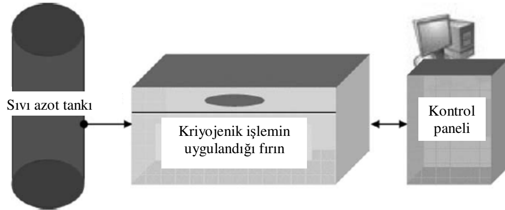
Şekil 4.1. Kriyojenik işlemin uygulandığı sistemin şeması [60]
