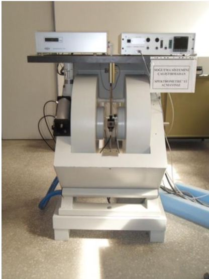
Şekil 2.9. Bruker EMX 131 X-Band ESR spektrometresi.
