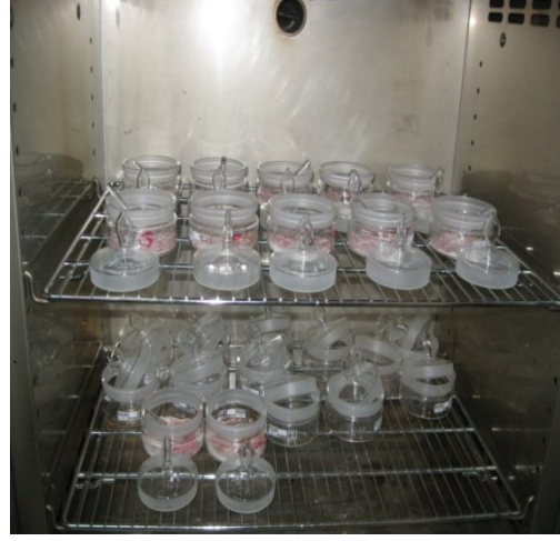
Şekil 2.2.103°C'lik Etüvde Kurutma
