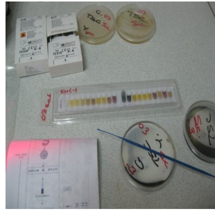
Şekil 2.12. Sucukta Clostridium spp. Kolonilerinin Tryptose- Sulfite- Cycloserine (TSC) agar'daki Gelişimleri
