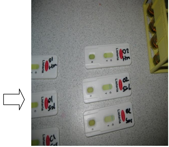
Şekil 2.25. Listeria Rapid Test Pozitif Kontrol
