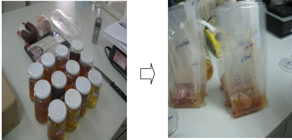
Şekil 2.17. Tamponlanmış Peptonlu Su Besiyerine Numunenin Tartılıp Stomacherden Geçirilerek Homojenize Edilmesi
