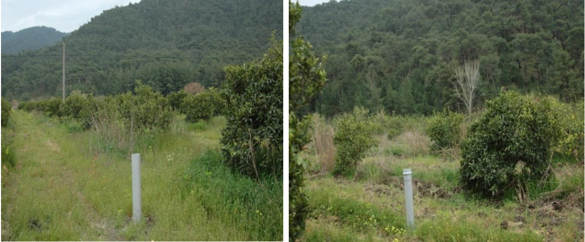
Şekil 6. Çalışma alanında bulunan farklı taban suyu gözlem boruları.
