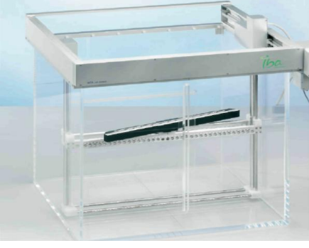
Şekil 3.1. Wellhöfer RFA 300 üç boyutlu su fantomu
