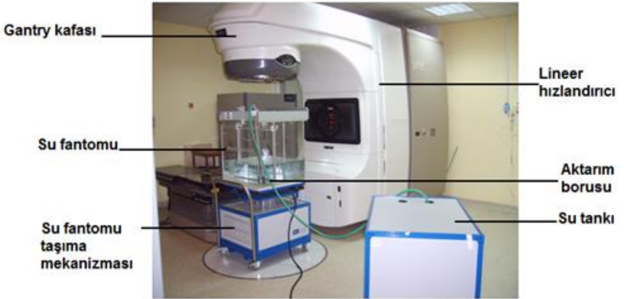
Şekil 3.2. Su fantomunun kurulumu ve doldurulması
