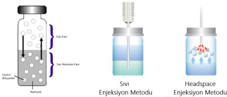
Şekil 2-42: Headspace gaz kromatografisi çalışma prensibi
