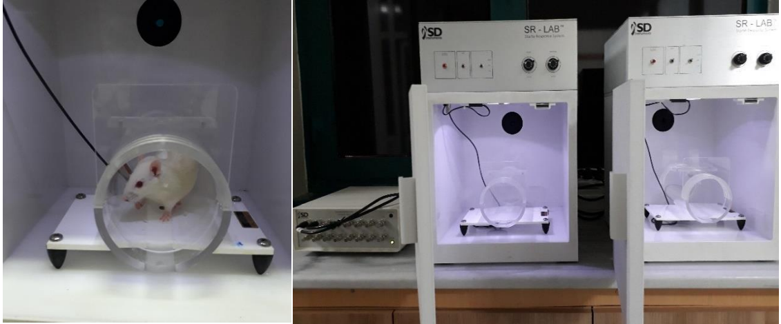
Şekil 18. Ön uyarı aracılı inhibisyon testi için ses geçirmez kabinden ve kabin içerisinde deney hayvanının hareketsiz kalmasını sağlayan pleksiglas kafesten oluşan test düzeneği.
