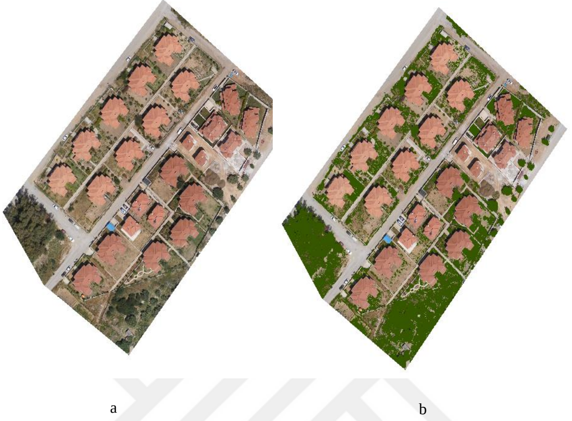
Şekil 4.2 a) Ortofoto görüntü, b) Ortofoto üzerine YAI görüntüsü.
