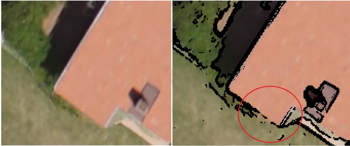
Şekil 6.5 Sobel filtre hatası.
