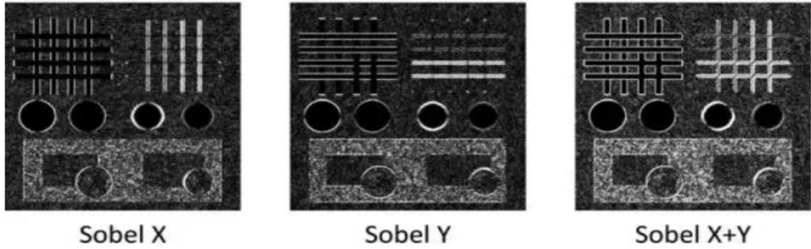
Şekil 4.18 Örnek sobel filtresi kenar çıkarımı (URL-19).
