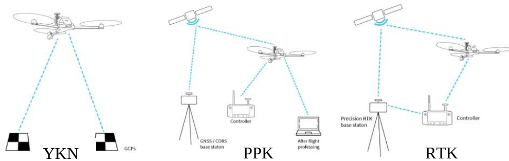
Şekil 3.3 RTK ve PPK’lı ölçüm yöntemi (URL-15).
