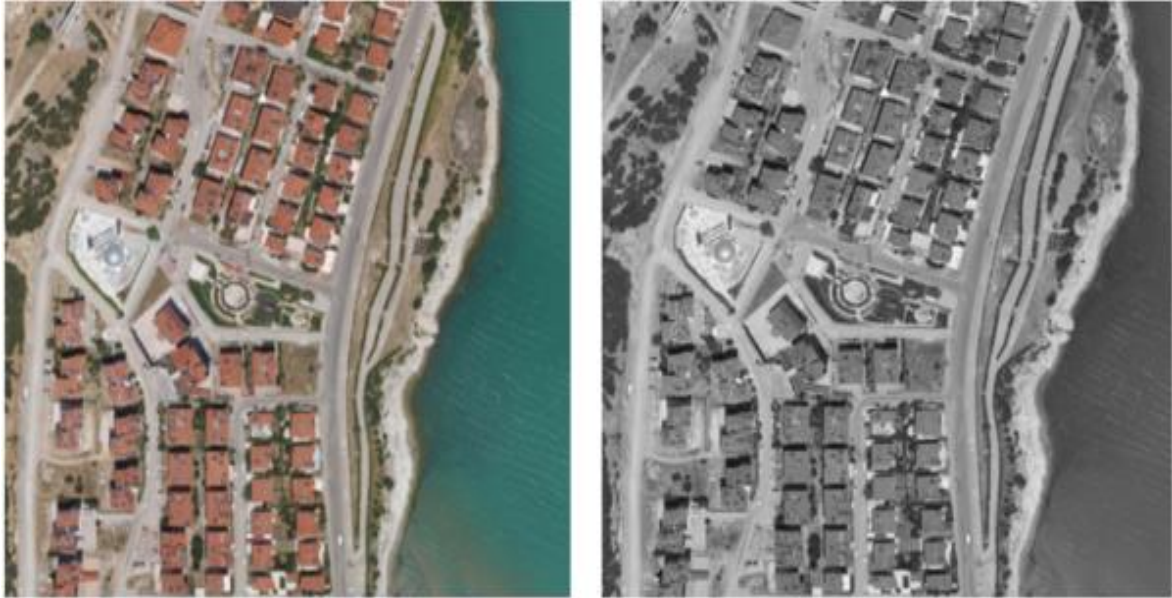
Şekil 2.15 a) KYM renk uzayında görüntü (3 bant), b) YTD renk uzayında, Y bileşeni ile elde edilmiş gri seviyeli yoğunluk görüntüsü (tek bant).
