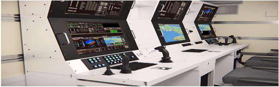
Şekil 2.1 İHA Sistemleri YKİ Örneği (URL-1).
