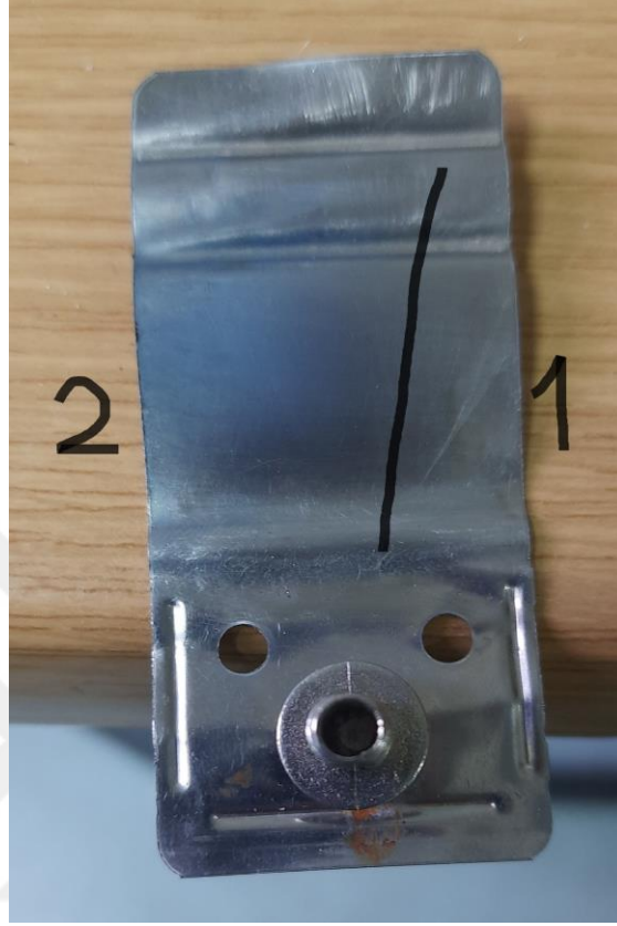
Şekil 3.8 Bias plate parçasının test sonrası renk değişimi.
