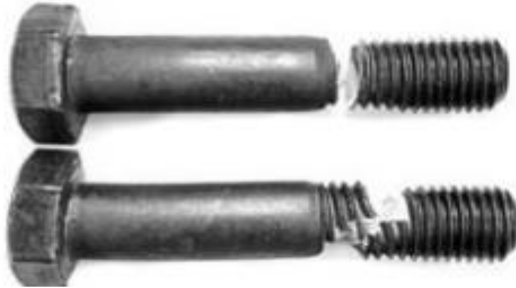
Şekil 3.20. Cıvata kırılması ( http-3 )
