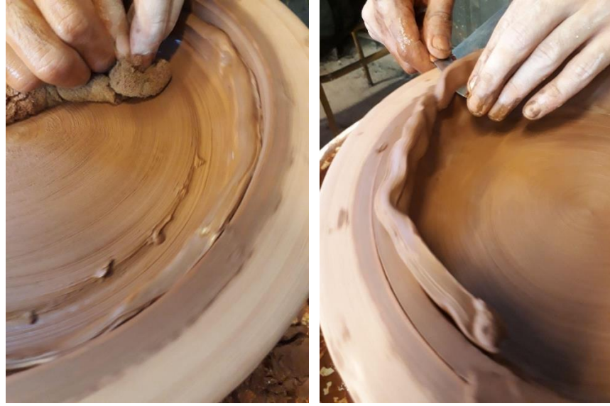
Şekil 84. Kap, çömlekçi çarkında seramik kalıp içine çamur sıkıştırılarak şekillendirilir (Fot. Füsun Çövenoğlu)
