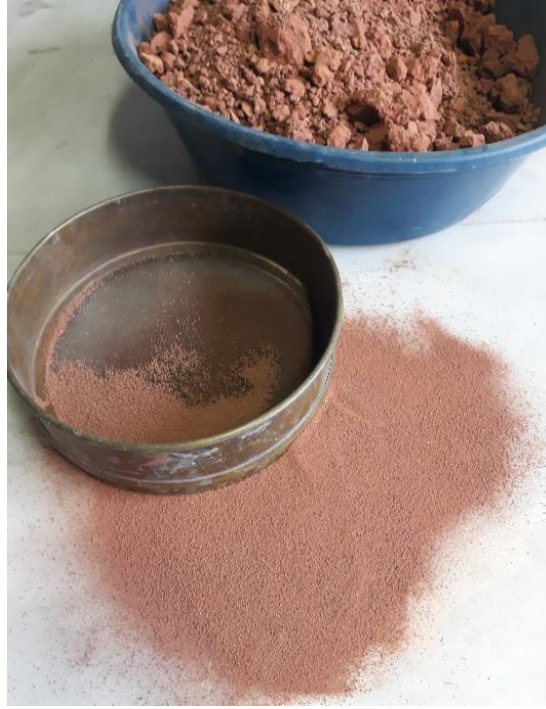
Şekil 72. 80 Mesh elekten geçirme işlemi (Fot. Füsun Çövenoğlu)
