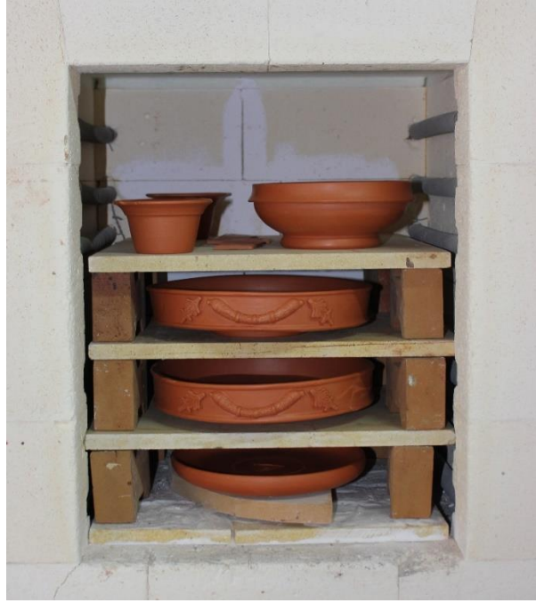
Şekil 119. Seramik pişirim fırını (Fot. Füsun Çövenoğlu)
