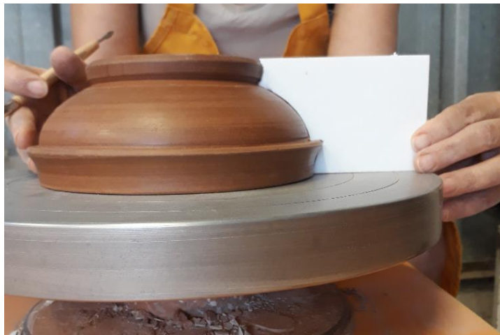
Şekil 117. Deri sertliğinde rötuş ile biçimlendirme (Fot. Füsun Çövenoğlu)
