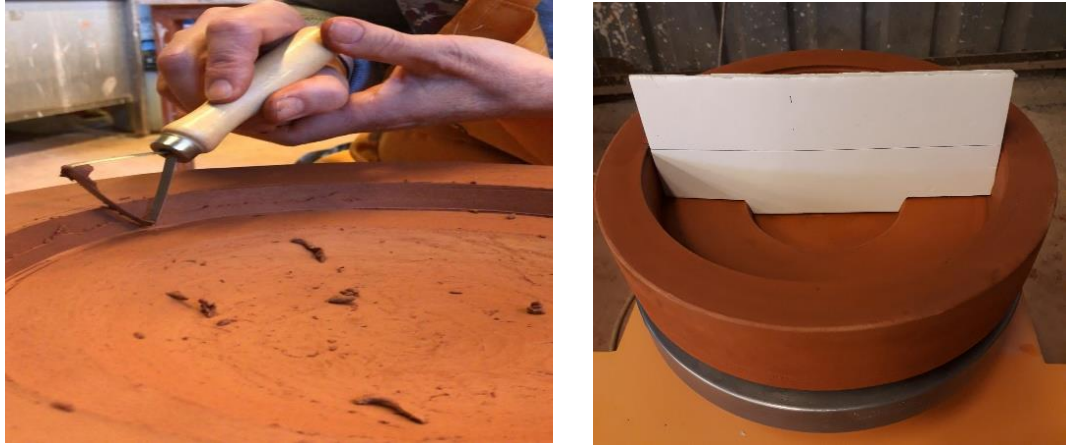
Şekil 80. Merkezlenen çamurun şablon kontrolü ile oyulması (Fot. Füsun Çövenoğlu)
