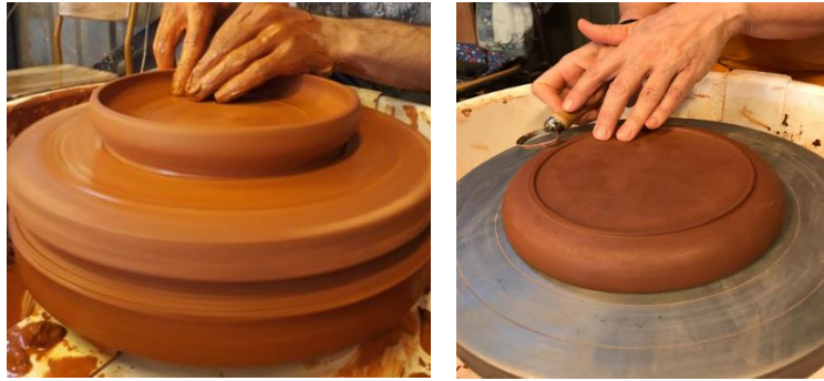
Şekil 104. Çömlekçi çarkında şekillendirme (solda), rötuşla ayak oluşturma (sağda),
