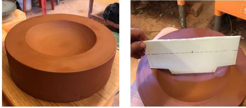
Şekil 80. Merkezlenen çamurun şablon kontrolü ile oyulması (Fot. Füsun Çövenoğlu)
