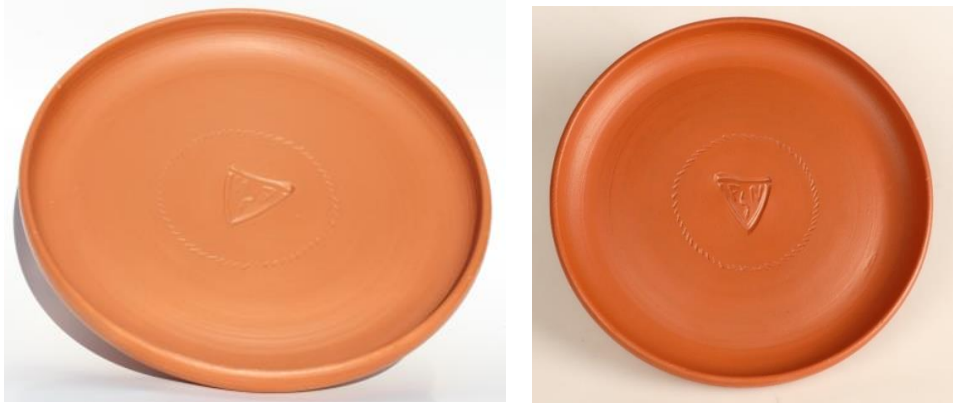
Şekil 121. 950 °C de pişirilen tabak (solda), 1050 °C de pişirilen tabak (sağda) (Fot. Levent Berber)
