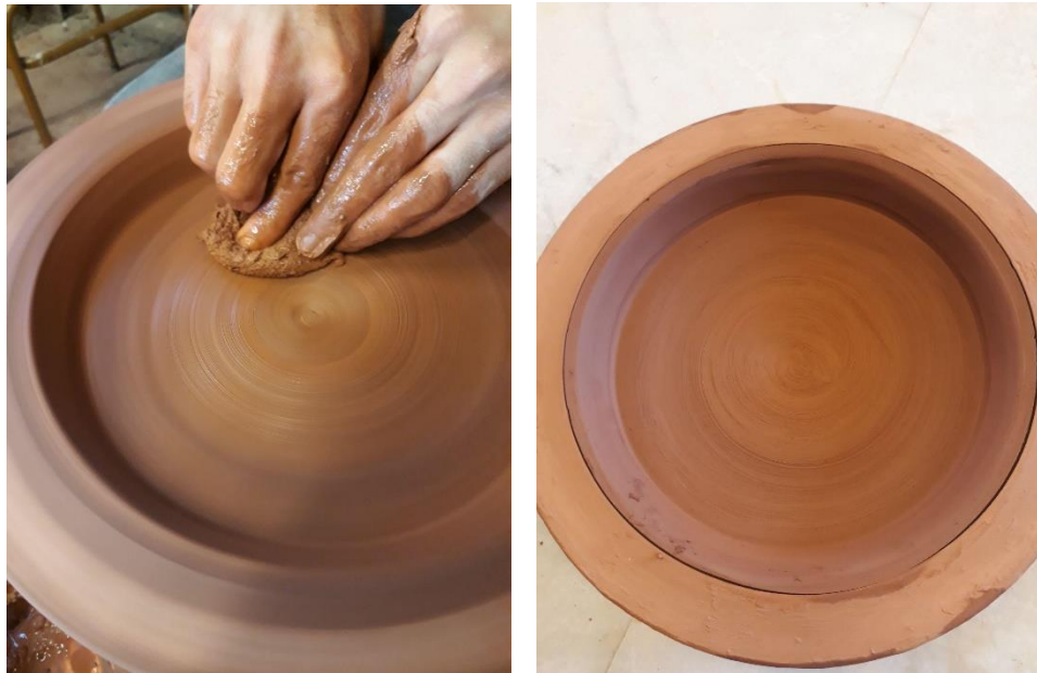
Şekil 85. Kalıp içine çamur sıvanması (solda), kalıp içinde şekillendirilen çamurun kurumaya bırakılması (Fot. Füsun Çövenoğlu)
