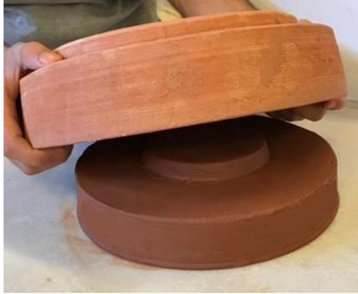
Şekil 86. Seramik kalıptan tabağın çıkarılması (Fot. Füsun Çövenoğlu)
