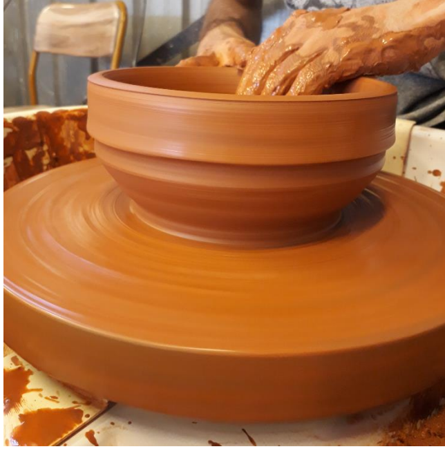
Şekil 116. Çömlekçi çarkında şekillendirme (Fot. Füsun Çövenoğlu)
