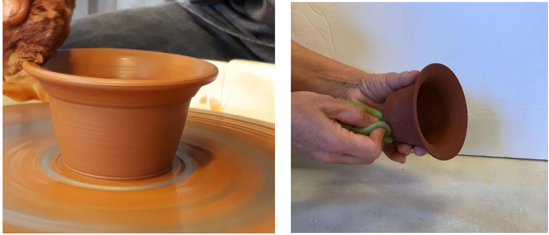
Şekil 108. Çömlekçi çarkında şekillendirme (solda), taban rötuşu (sağda), (Fot. Füsün Çövenoğlu)
