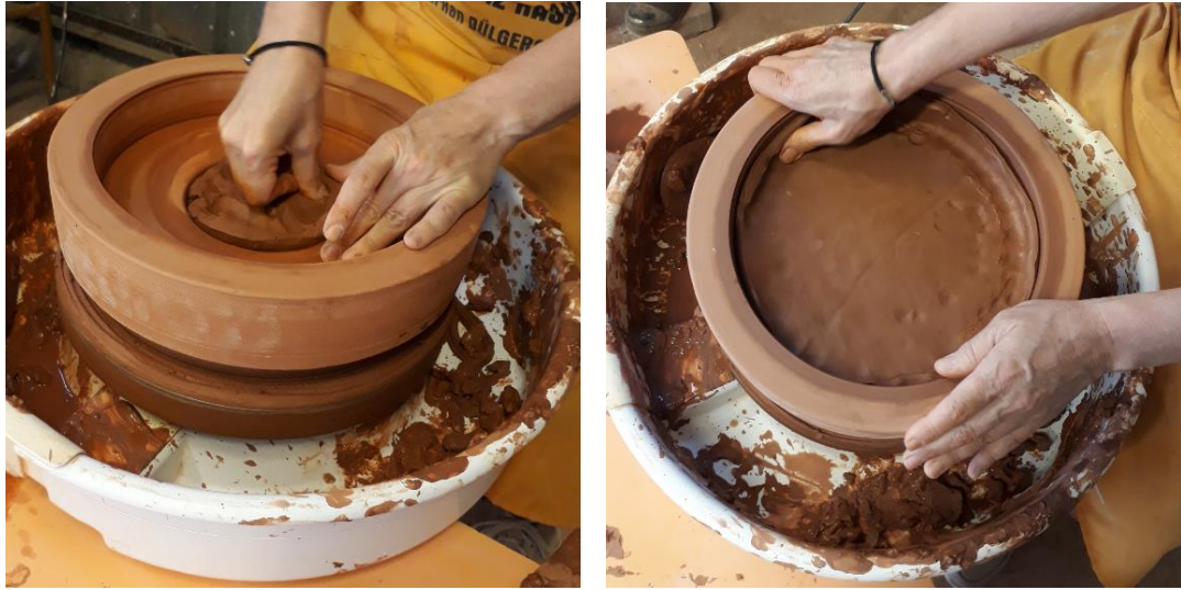
Şekil 83. Seramik kalıba çamur basma işlemi (Fot. Füsün Çövenoğlu)
