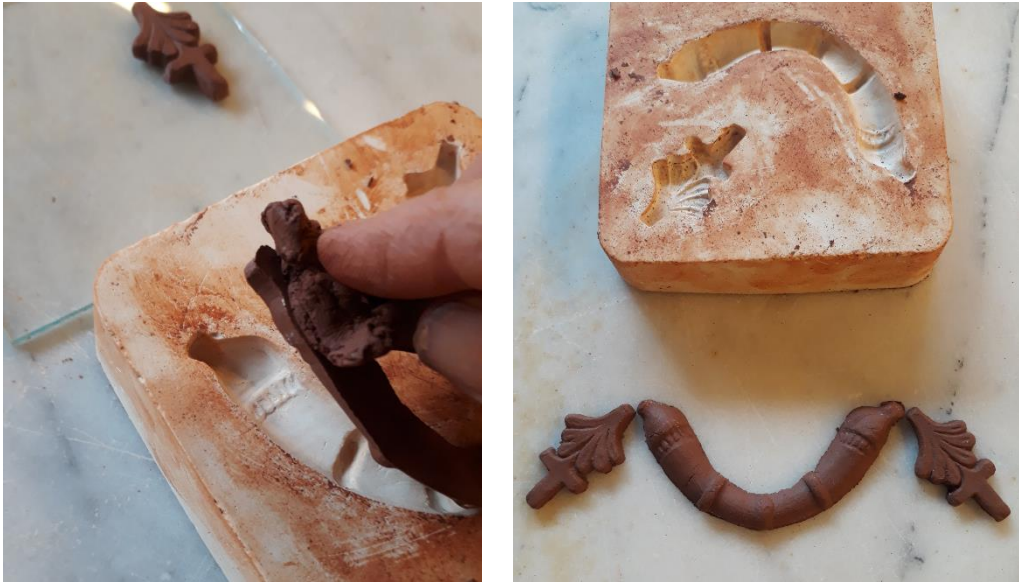
Şekil 92. Alçı kalıba çamur basılarak applike birimlerin çoğaltımı (Fot. Füsun Çövenoğlu)
