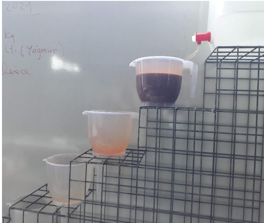
Şekil 69. Dört basamaklı kil yıkama düzeneği (Fot. Füsun Çövenoğlu)
