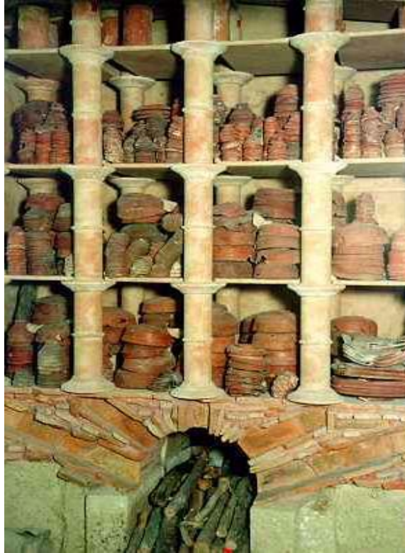
Şekil 40. Tübüler fırın kesiti (Sabine Jäger-Wersonig, 2018) Erişim Tarihi: 21.01.2021
