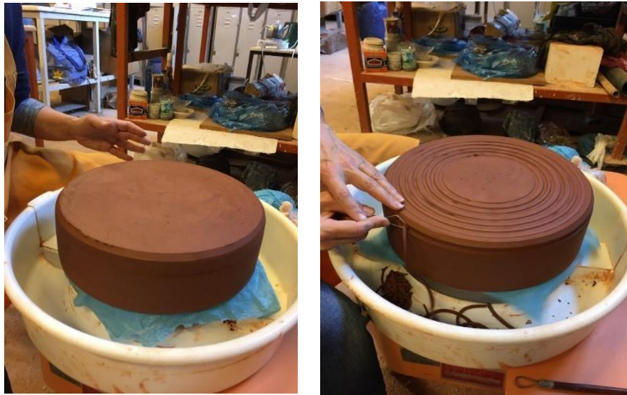
Şekil 79. Çamur kütlelerinin çömlekçi tornasında merkezleme işlemi (Fot. Füsün Çövenoğlu)
