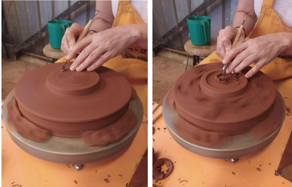
Şekil 87. Taban kısmı dolu olarak seramik kalıp içinde şekillendirilen tabağın ayak kısmının oluşturulması (Fot. Füsun Çövenoğlu)
