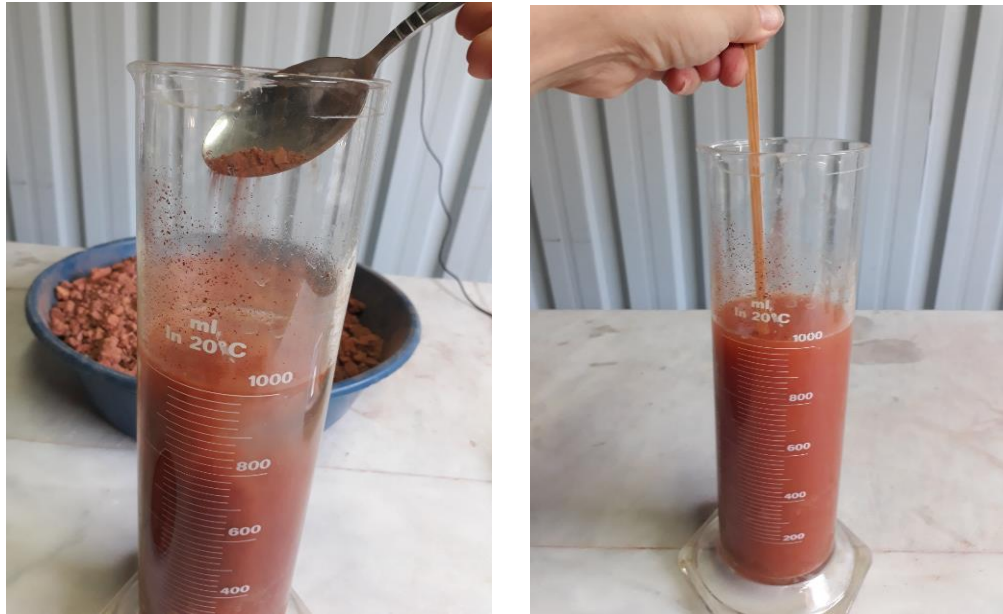
Şekil 75. Silikat karışımına suya kil ekleme aşaması (solda), karıştırma aşaması (sağda), (Fot. Füsün Çövenoğlu)
