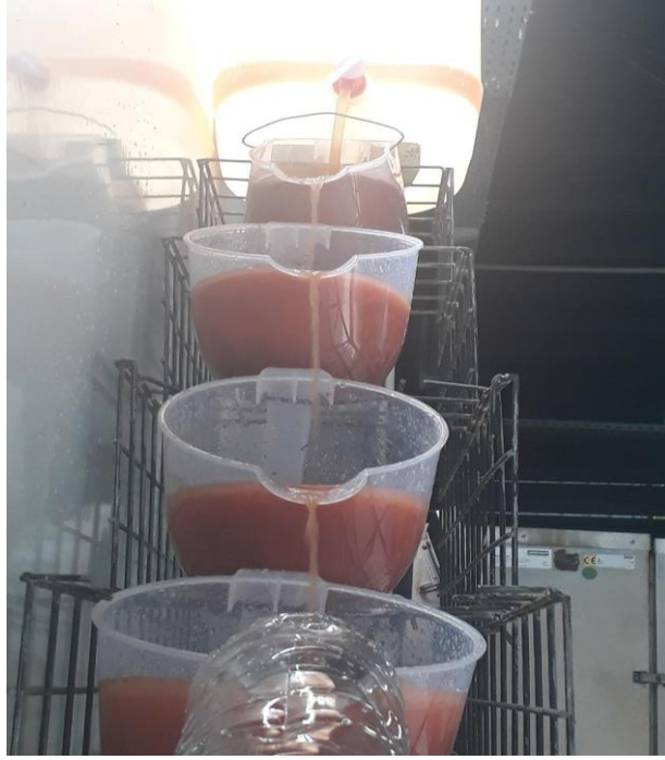
Şekil 70. Dört basamaklı kil yıkama düzeneği (Fot. Füsun Çövenoğlu)
